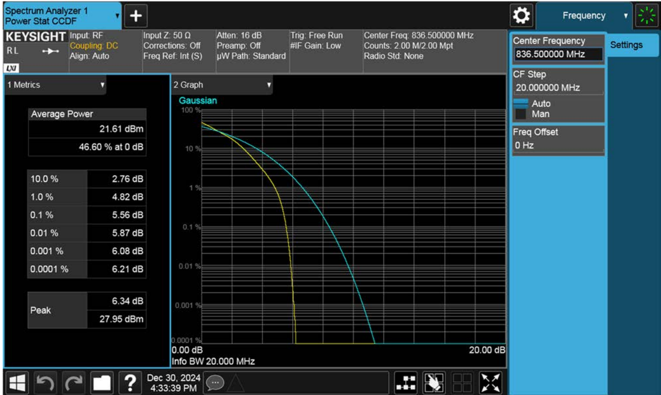
PAR Plot (20 M BW Ch.167300 16QAM RB 100_0)
