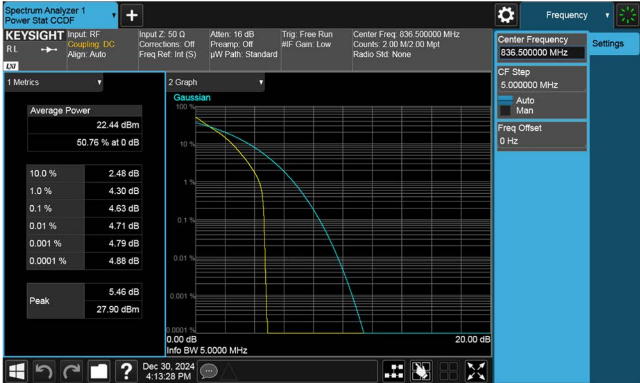
PAR Plot (5 M BW Ch.167300 QPSK_RB 25_0)
