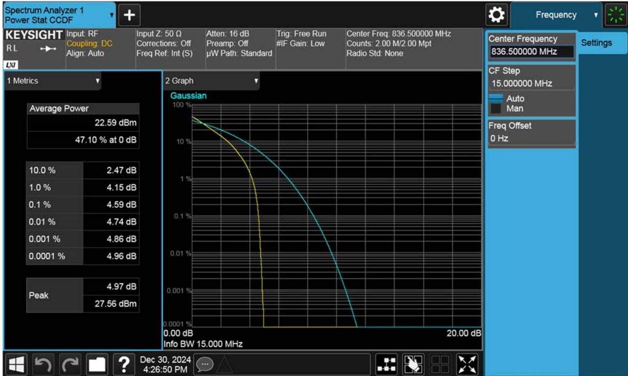
PAR Plot (15 M BW Ch.167300 QPSK RB 75_0)
