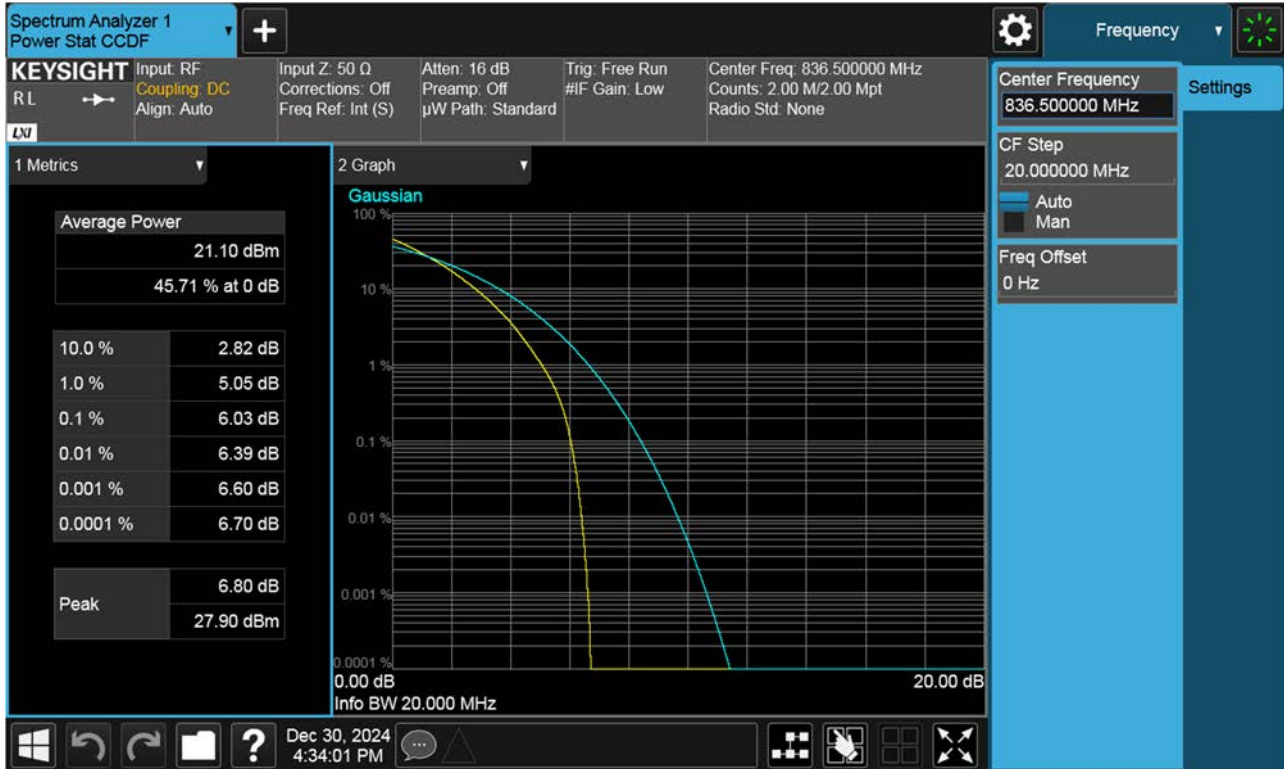
PAR Plot (20 M BW Ch.167300 64QAM RB 100_0)
