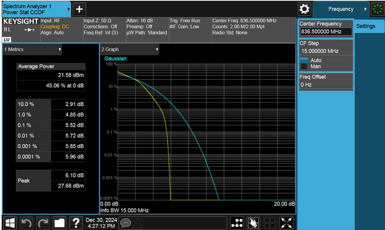
PAR Plot (15 M BW Ch.167300 16QAM RB 75_0)
