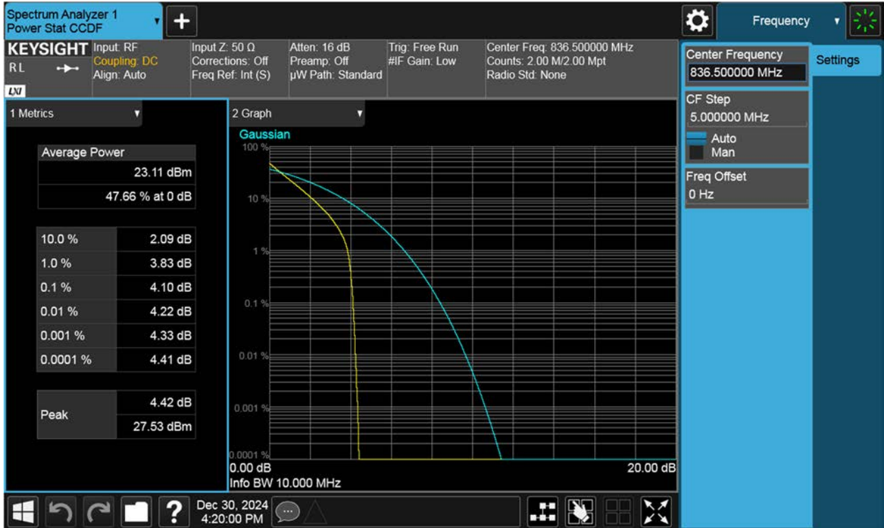
PAR Plot (10 M BW Ch.167300 BPSK_RB 50_0)
