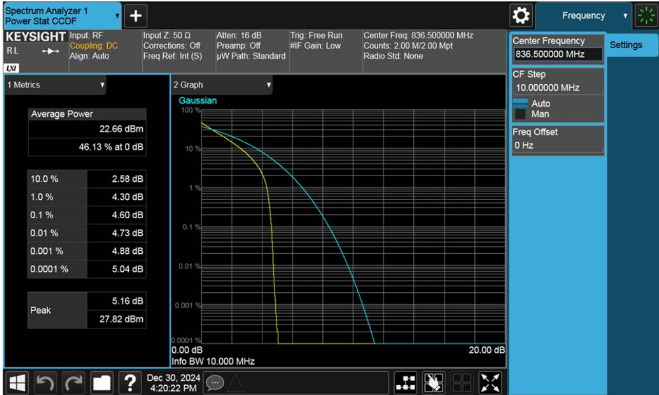
PAR Plot (10 M BW Ch.167300 QPSK_RB 50_0)
