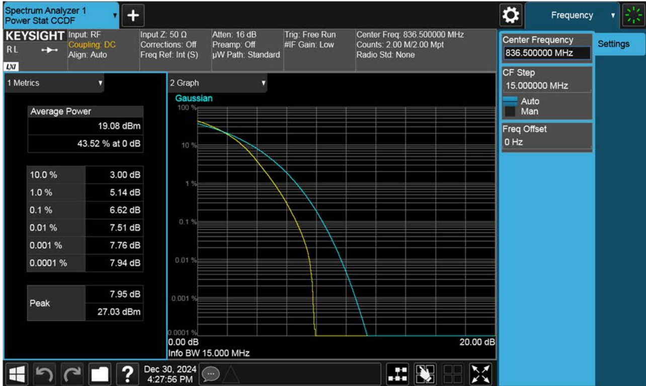
PAR Plot (15 M BW Ch.167300 256QAM RB 75_0)
