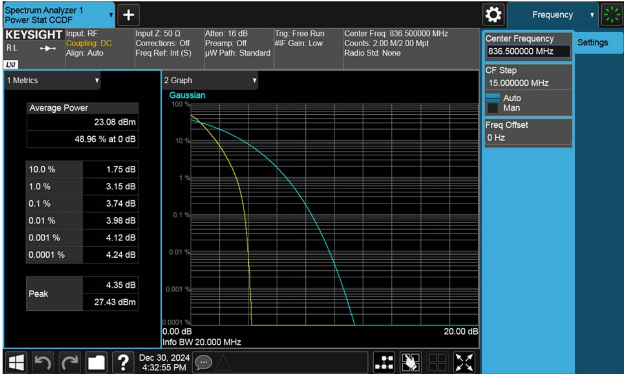
PAR Plot (20 M BW Ch.167300 BPSK RB 100_0)
