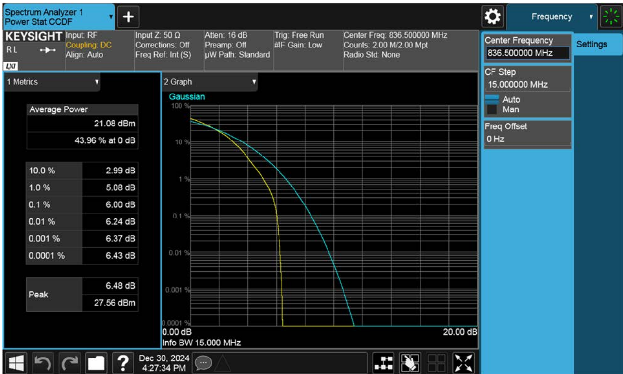
PAR Plot (15 M BW Ch.167300 64QAM RB 75_0)
