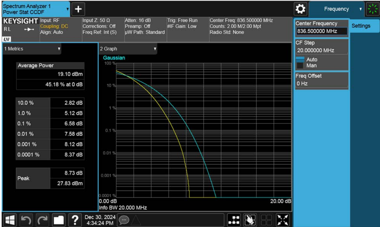
PAR Plot (20 M BW Ch.167300 256QAM RB 100_0)
