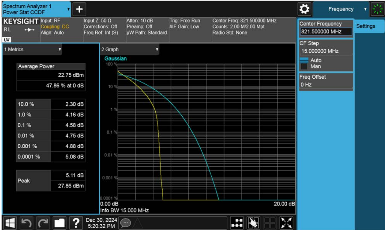
Sub6 n26. PAR Plot (15 M BW Ch.164300 QPSK RB 75_0)
