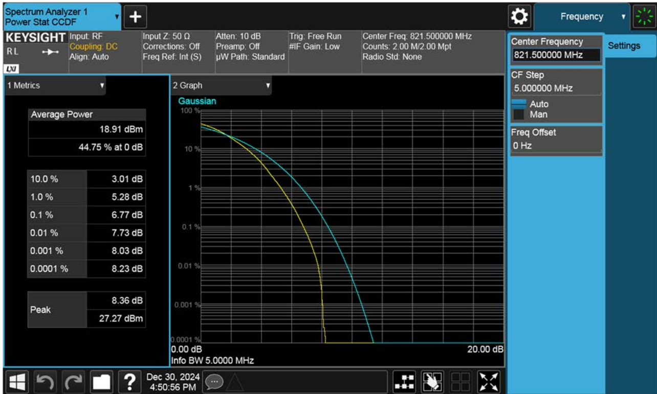
Sub6 n26. PAR Plot (5 M BW Ch.164300 256QAM RB 25_0)
