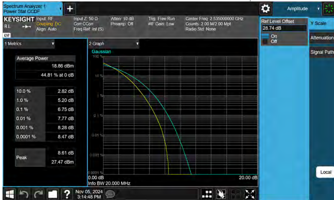
Sub6 n7. PAR Plot (20 M BW_Ch.507000_256QAM)
