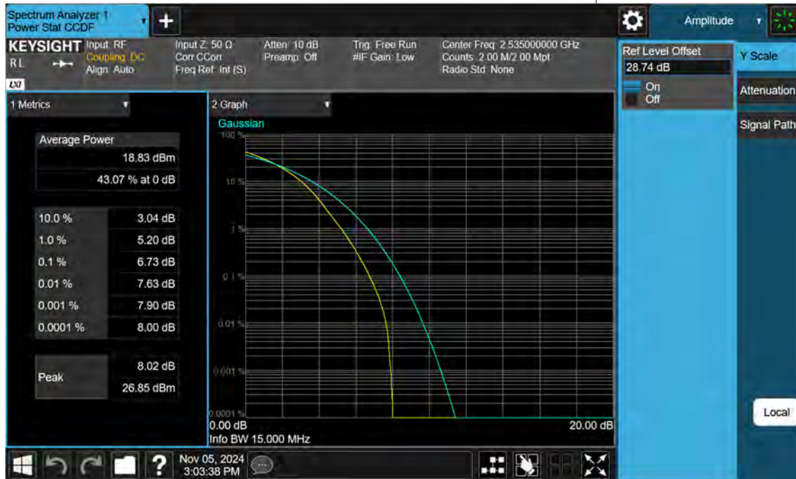
Sub6 n7. PAR Plot (15 M BW_Ch.507000_256QAM)
