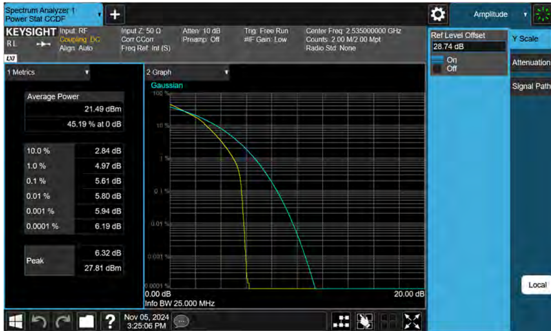
Sub6 n7. PAR Plot (25 M BW_Ch.507000_16QAM)
