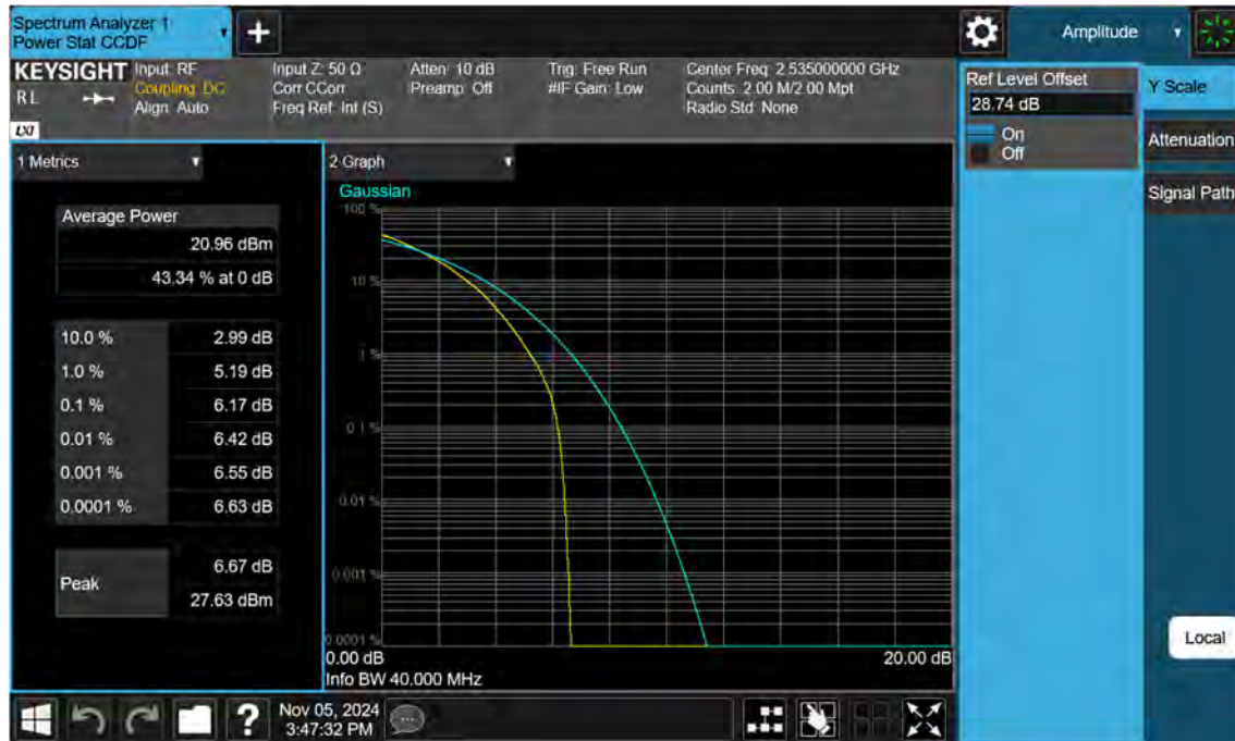
Sub6 n7. PAR Plot (40 M BW_Ch.507000_64QAM)
