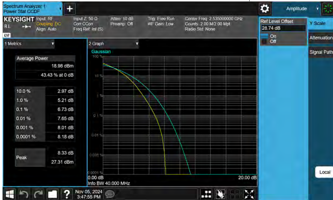
Sub6 n7. PAR Plot (40 M BW_Ch.507000_256QAM)
