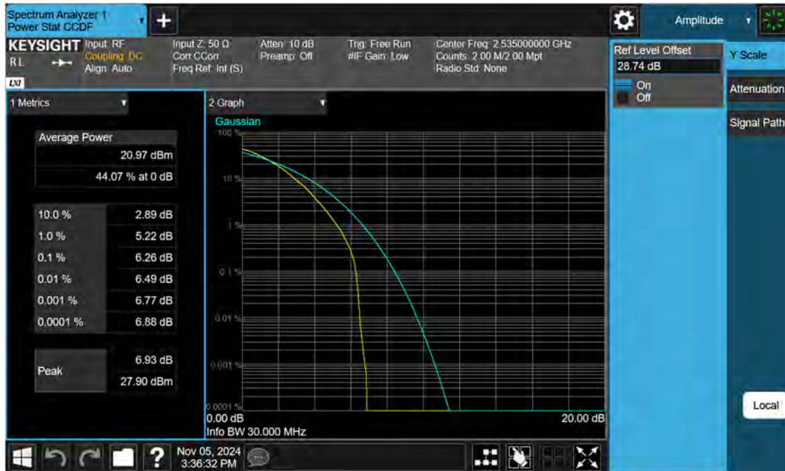
Sub6 n7. PAR Plot (30 M BW_Ch.507000_64QAM)
