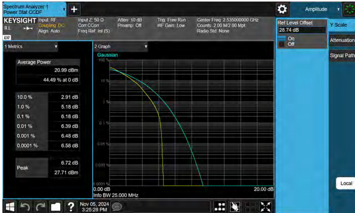
Sub6 n7. PAR Plot (25 M BW_Ch.507000_64QAM)
