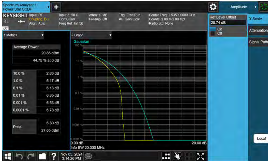
Sub6 n7. PAR Plot (20 M BW_Ch.507000_64QAM)
