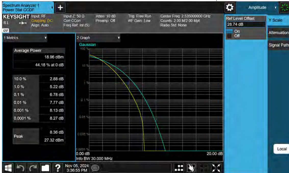
Sub6 n7. PAR Plot (30 M BW_Ch.507000_256QAM)
