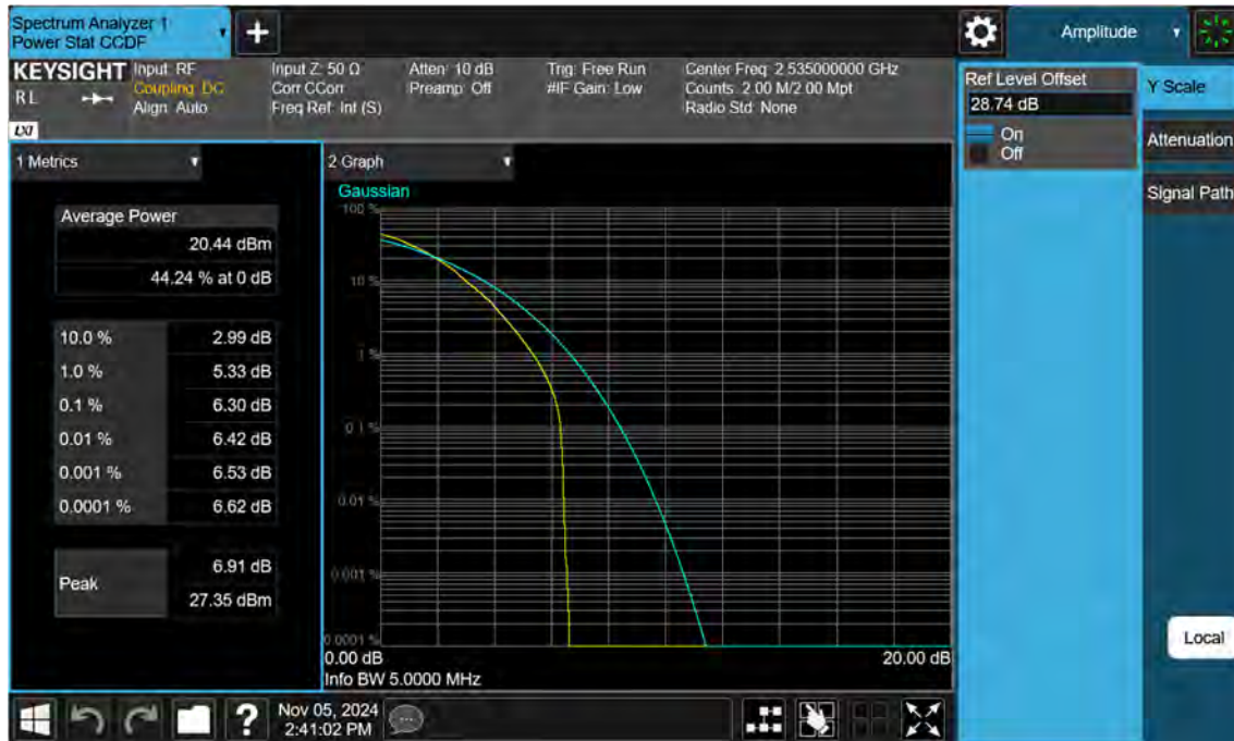
Sub6 n7. PAR Plot (5 M BW_Ch.507000_64QAM)
