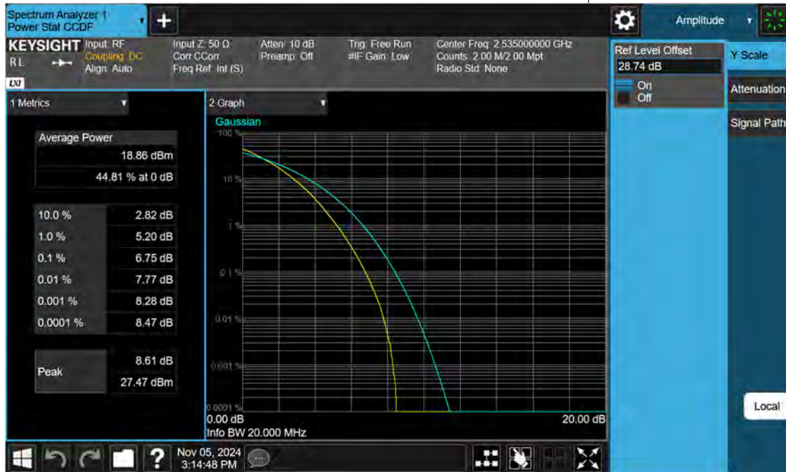
Sub6 n7. PAR Plot (20 M BW_Ch.507000_256QAM)
