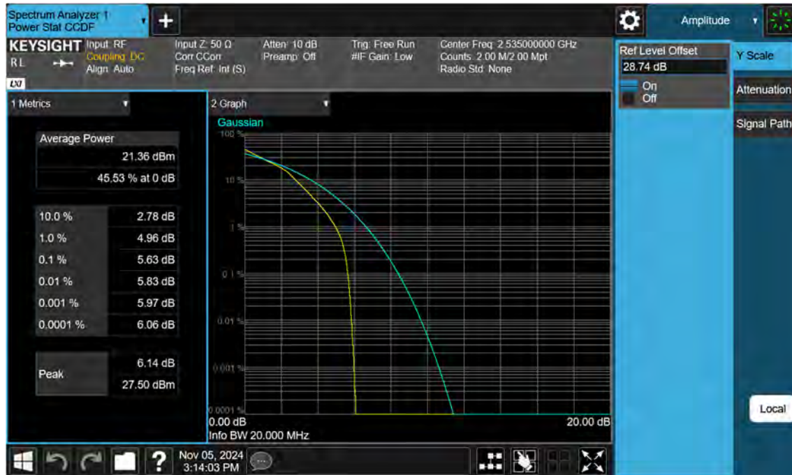
Sub6 n7. PAR Plot (20 M BW_Ch.507000_16QAM)
