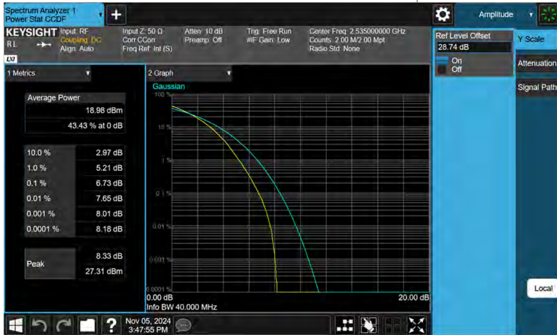
Sub6 n7. PAR Plot (40 M BW_Ch.507000_256QAM)
