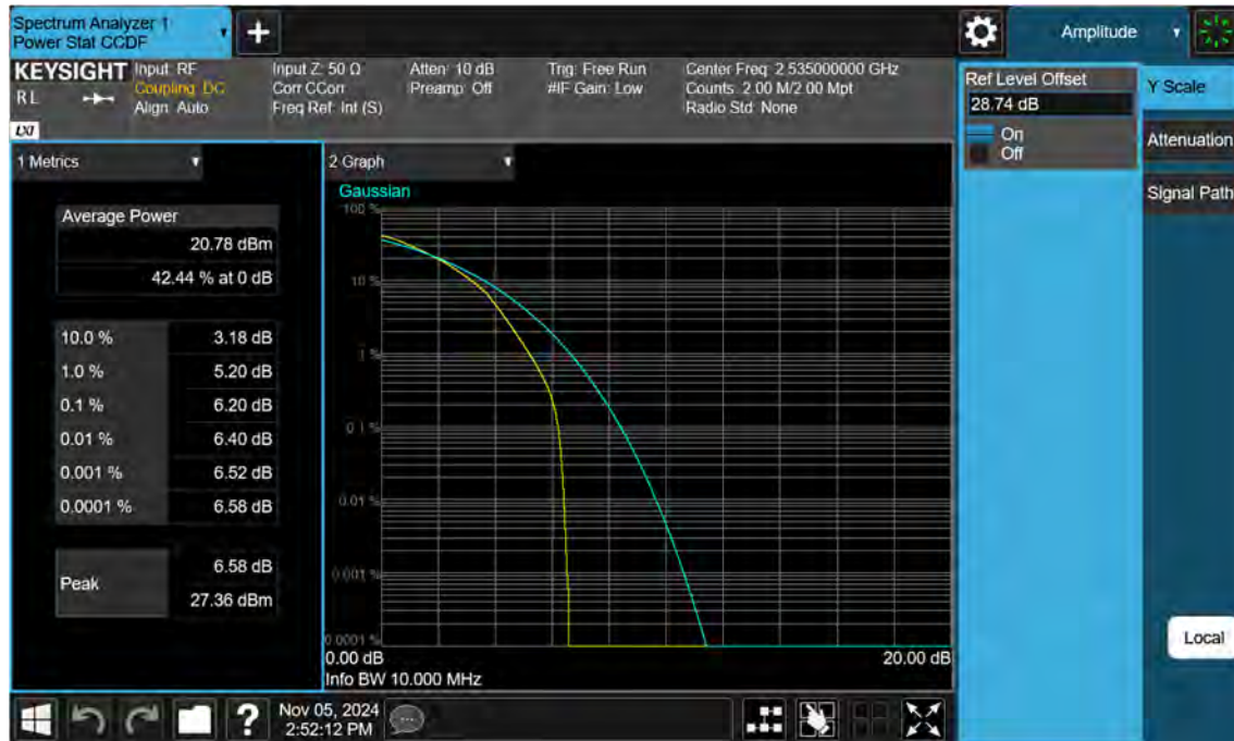
Sub6 n7. PAR Plot (10 M BW_Ch.507000_64QAM)
