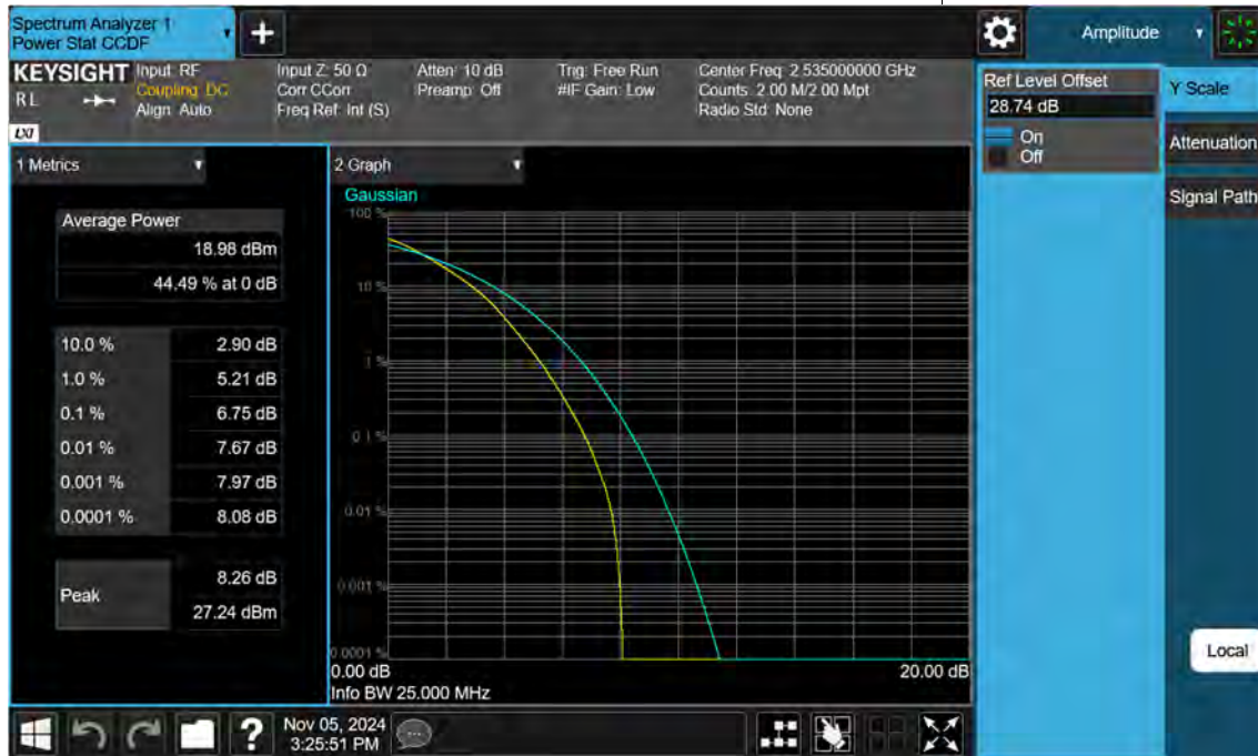
Sub6 n7. PAR Plot (25 M BW_Ch.507000_256QAM)
