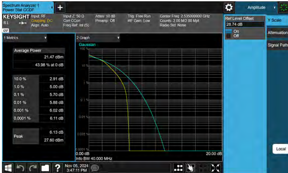
Sub6 n7. PAR Plot (40 M BW_Ch.507000_16QAM)
