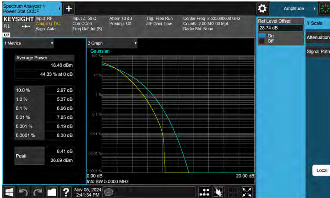
Sub6 n7. PAR Plot (5 M BW_Ch.507000_256QAM)
