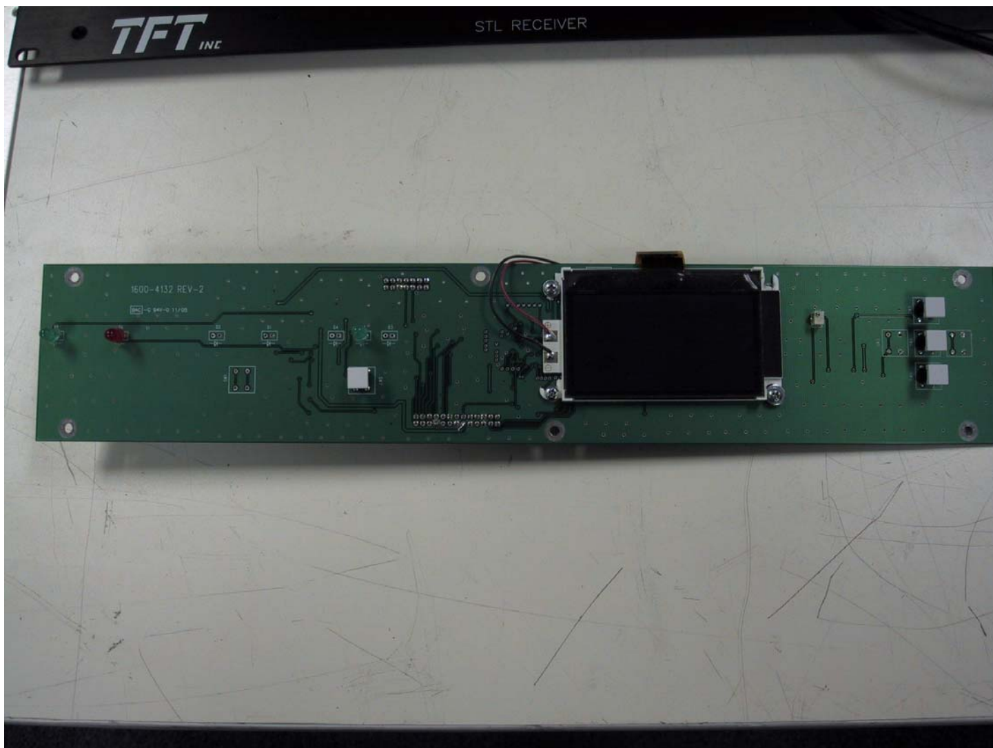
Display PCB – Bottom
