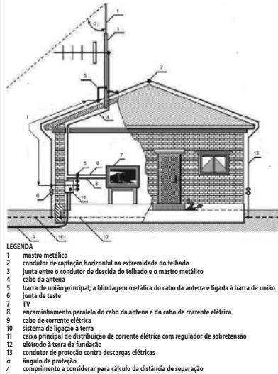
Figura E.32b – Antena de TV utilizando o mastro como ponteira de captação
