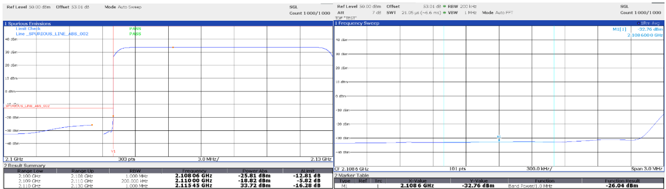
Band Edge. TX:2120MHz, BW: 20MHz, MOD: 256QAM
