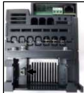
Fan power connection
