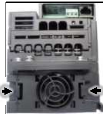
Fan assembly removal
