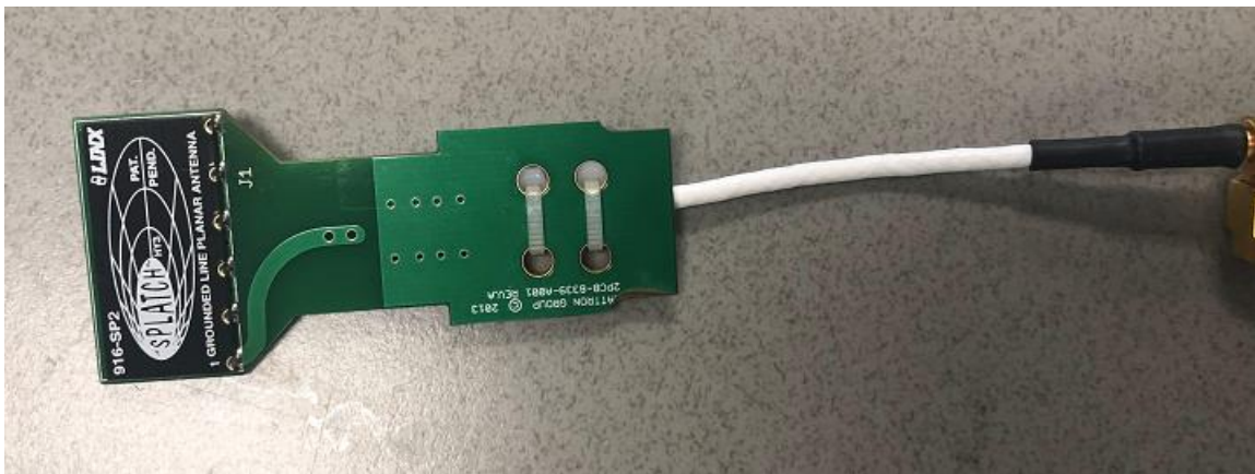
900MHz Chip antenna
