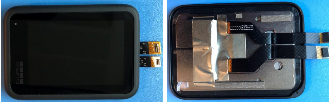
640-28968-000/640-28967-000/640-28969-000, Rear LCD module, SPBL1
