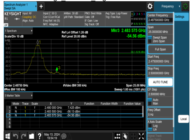
Band Edge BLE 1M HighCH39-2480MHz
