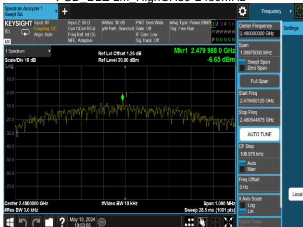
PSD BLE 1M HighCH39-2480MHz
