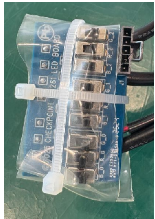
4. APPLY CABLE TIES (ITEM390)
