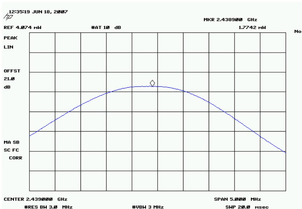
**GFSK (Lowest Data Rate DH5), High Channel**
