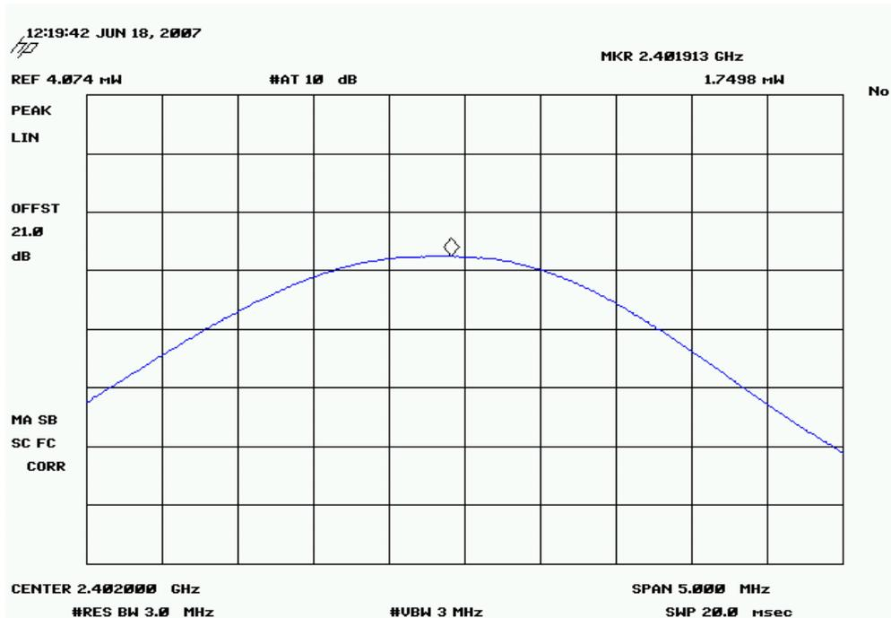
**GFSK (Lowest Data Rate DH5), Mid Channel**
