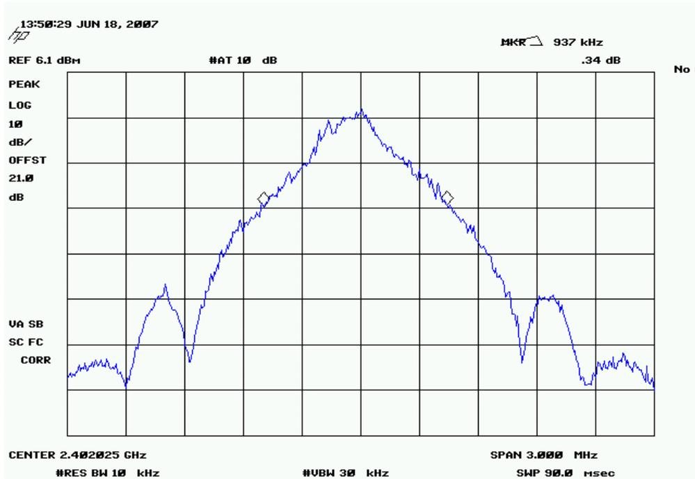
GFSK (Lowest Data Rate DH5), Mid Channel
