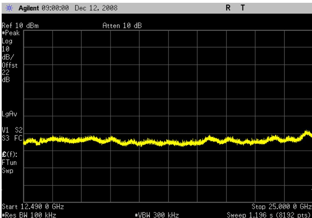
pi/4-DQPSK, 2DH5, Mid Channel, 30MHz - 12.5GHz
