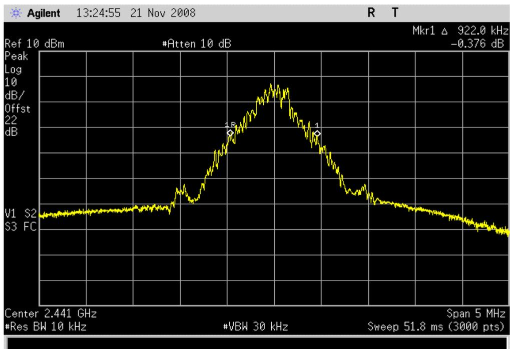
GFSK, DH5, High Channel, 2480 MHz
