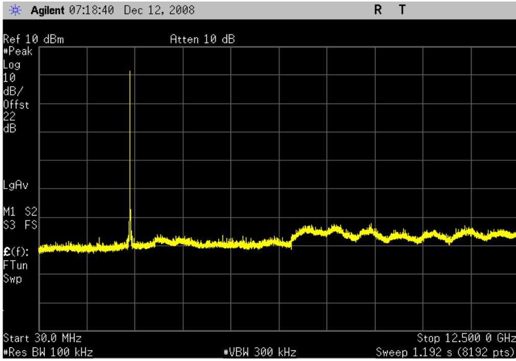
GFSK, DH5, Low Channel, 12.4GHz-25GHz
