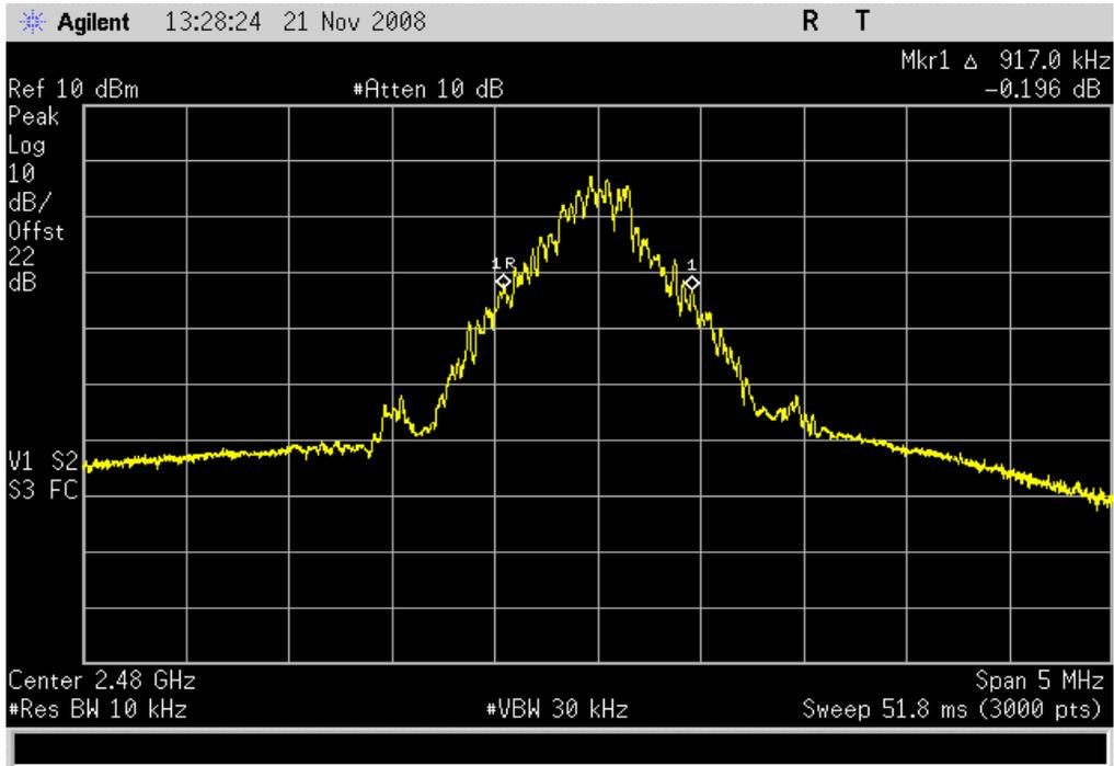
pi/4-DQPSK, 2DH5, Low Channel, 2402MHz
