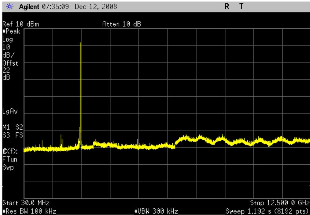
GFSK, DH5, High Channel, 12.4GHz-25GHz
