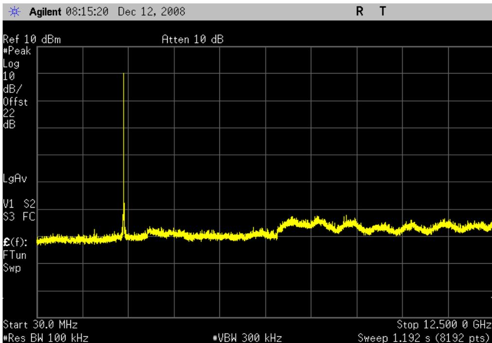
pi/4-DQPSK, 2DH5, Low Channel, 12.4GHz-25GHz
