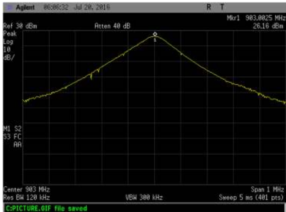
Channel 1 of 120 903.0 MHz AM OOK +27dbm nominal
