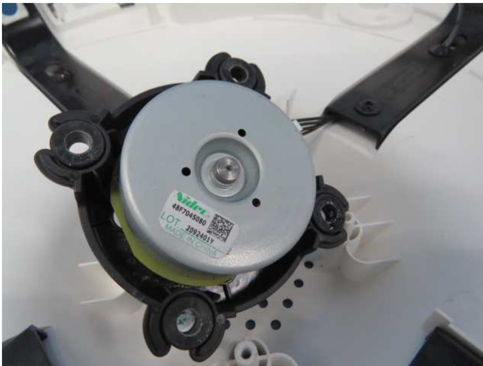
Fan motor view
