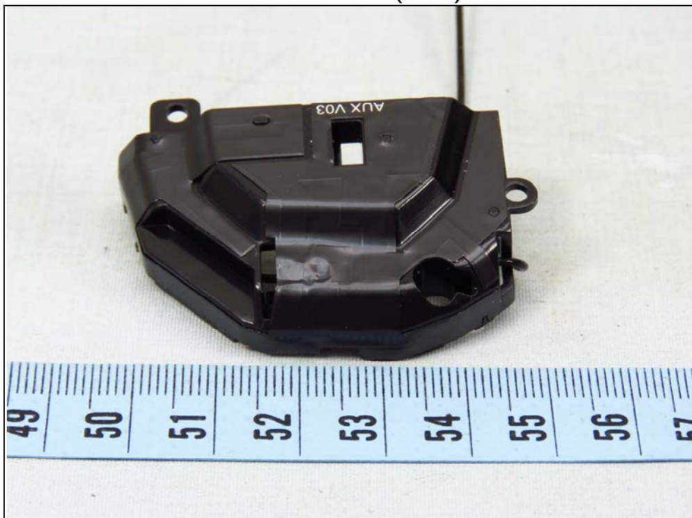
LTE antenna (Aux.)
