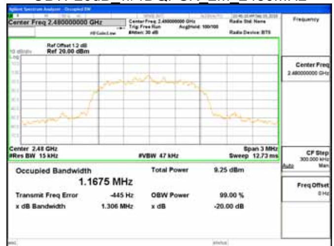
OBW 20dB \pi /4DQPSK 2M 2480MHz
