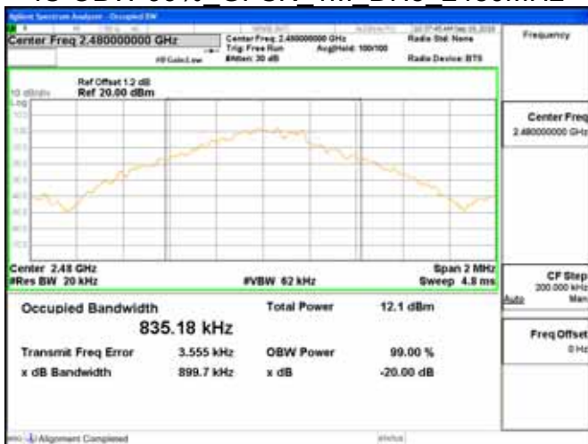
IC OBW 99% GFSK 1M DH5 2480MHz
