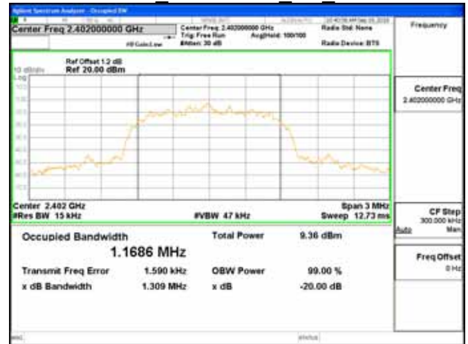
OBW 20dB \pi /4DQPSK 2M 2441MHz
