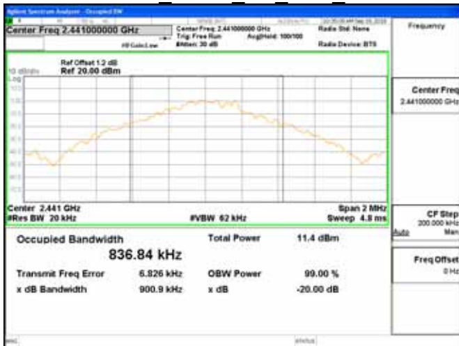
IC OBW 99% GFSK 1M DH5 2480MHz
