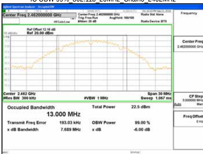
IC OBW 99% 802.11b 20MHz Chain0 2462MHz
