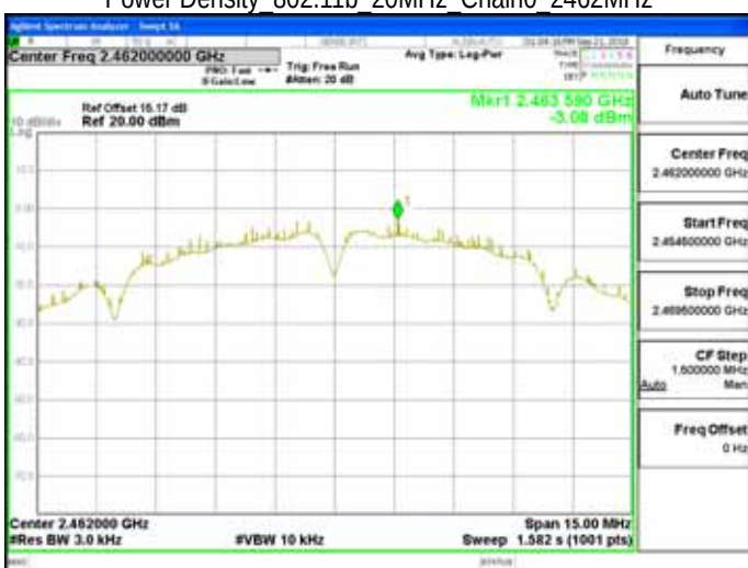
Power Density 802.11b 20MHz Chain0 2462MHz
