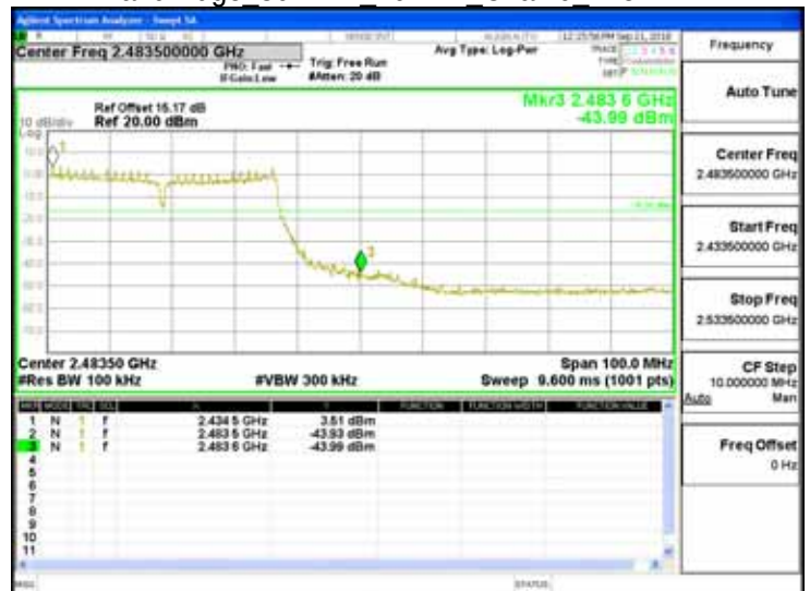
Band Edge 802.11n 40MHz Chain0 2452MHz
