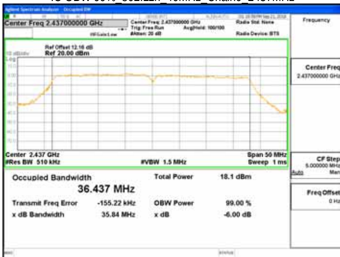
IC OBW 99% 802.11n 40MHz Chain0 2452MHz
