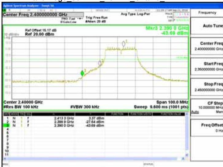
Band Edge 802.11n 20MHz Chain0 2462MHz
