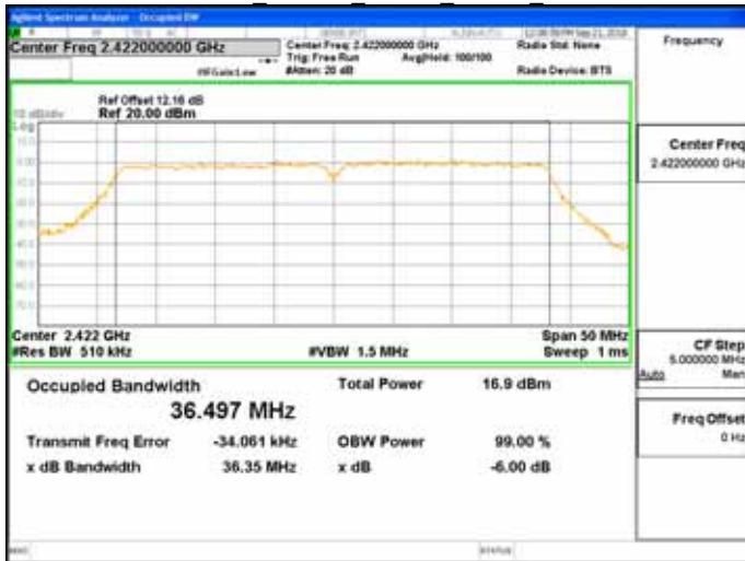
IC OBW 99% 802.11n 40MHz Chain0 2437MHz
