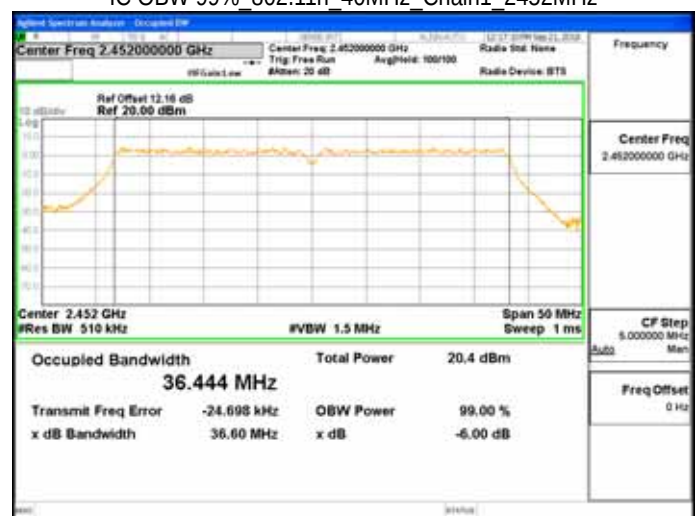
IC OBW 99% 802.11n 40MHz Chain1 2452MHz
