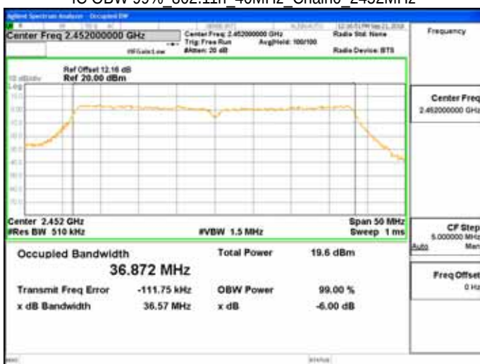
IC OBW 99% 802.11n 40MHz Chain0 2452MHz
