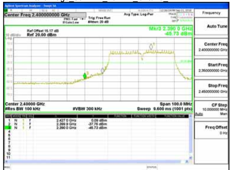
Band Edge 802.11n 40MHz Chain0 2452MHz
