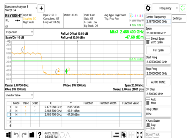
Hopping Band Edge 8DPSK 3M DH5 2480MHz
