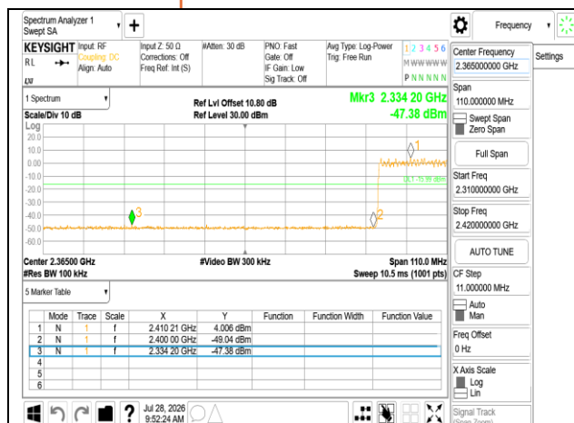
Hopping Band Edge 8DPSK 3M DH5 2402MHz
