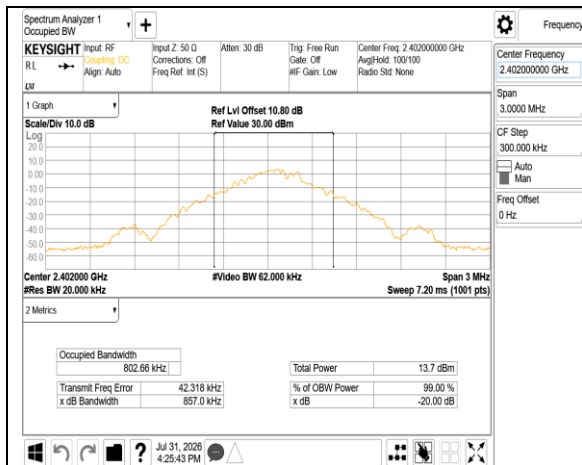
OBW 20dB GFSK 1M DH5 2402MHz
