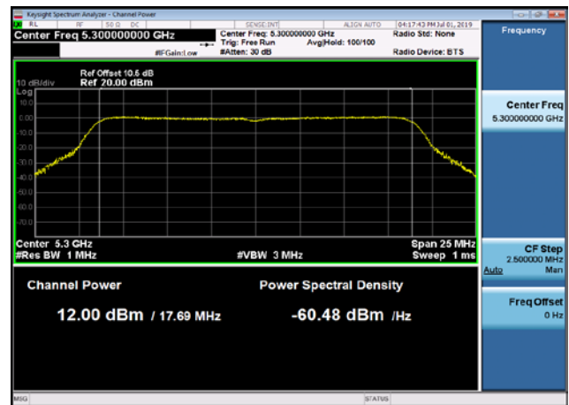
U-NII-2a Output Power-802.11ac(20MHz) ,5300MHz
