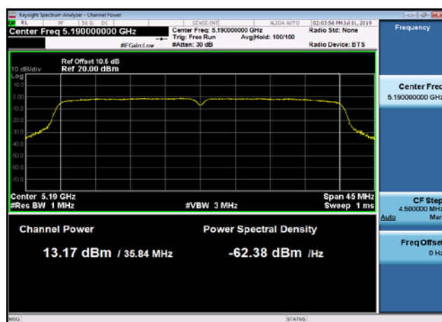
U-NII-1 Output Power-802.11ac(40MHz) ,5190MHz
