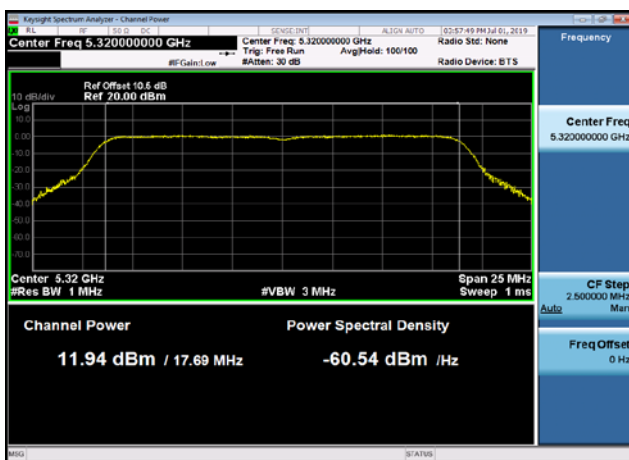
U-NII-2a Output Power-802.11n(20MHz) ,5320MHz
