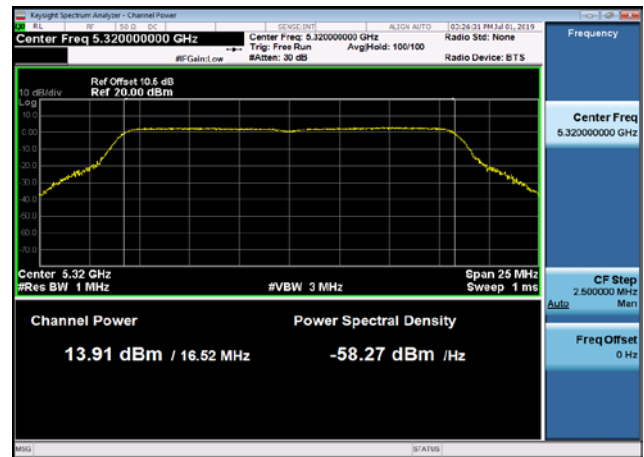
U-NII-2a Output Power-802.11ac(20MHz) ,5300MHz
