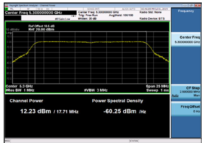
U-NII-2a Output Power-802.11n(40MHz) ,5270MHz
