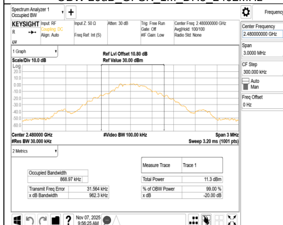
OBW 20dB GFSK 1M DH5 2480MHz
