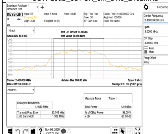
OBW 20dB 8DPSK 3M DH5 2480MHz
