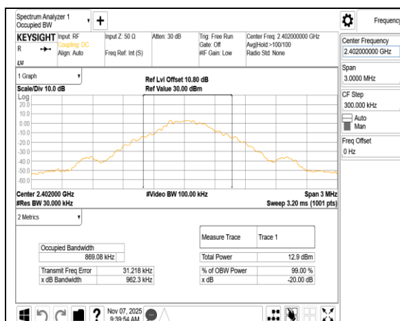
OBW 20dB GFSK 1M DH5 2402MHz
