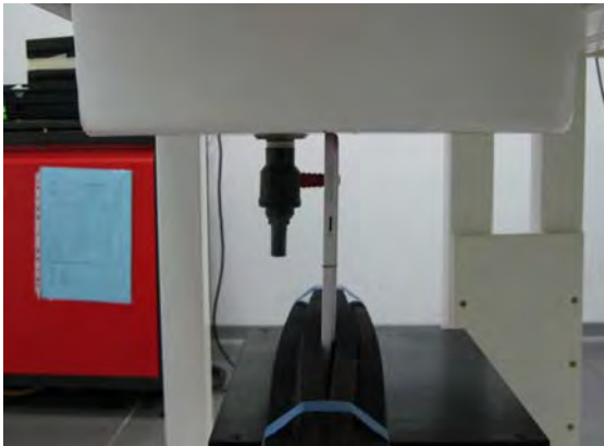
Fig.4 EUT Edge 1 to flat phantom
