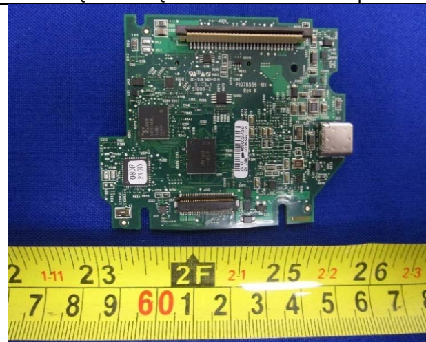
EUT AC Radio Version M/N: ZQ320 P/N: ZQ32-A0W01R0-001 PCBA A - Top
