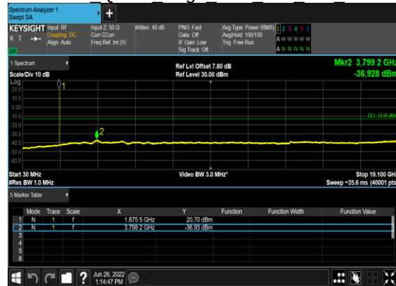
B7_N2(10M)_DFT-s-OFDM QPSK Edge 1RB Left Mid CH
