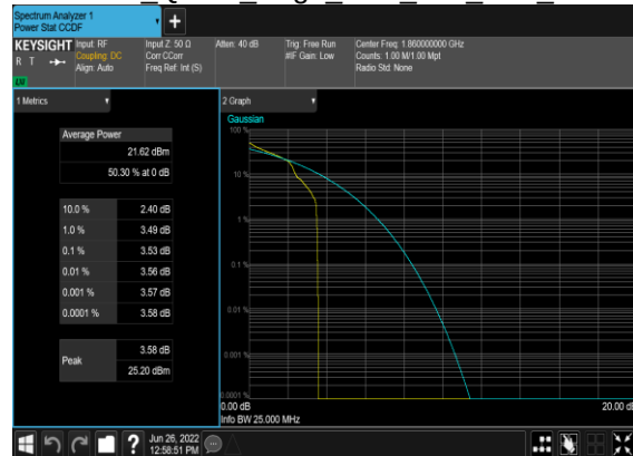
B7_N2(20M)_DFT-s-OFDM QPSK Edge 1RB Left Low CH
