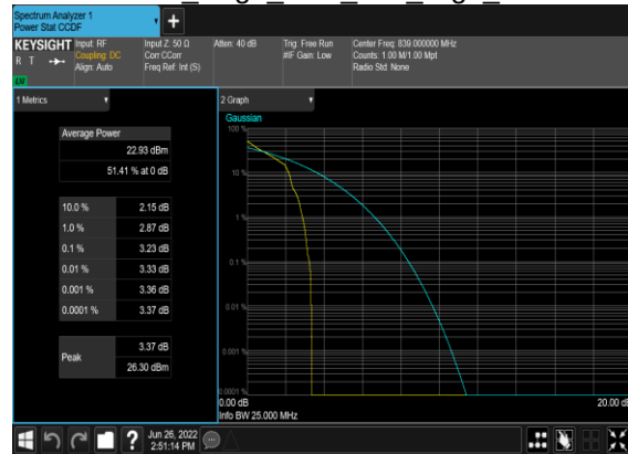
B7_N5(20M)_DFT-s-OFDM_PI_2-BPSK Edge 1RB Left High CH
