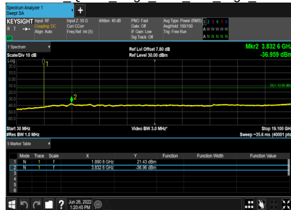
B7_N2(20M)_DFT-s- OFDM QPSK Edge 1RB Left High CH
