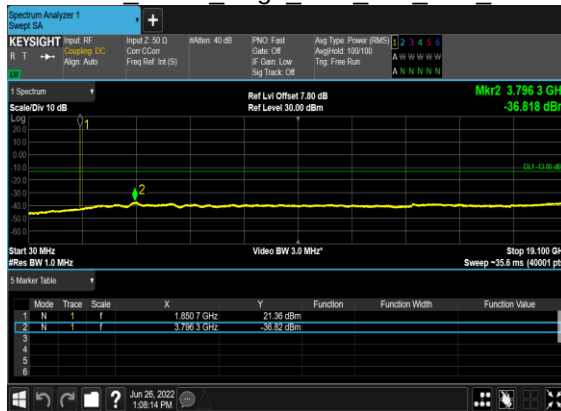
B7_N2(5M)_DFT-s-OFDM BPSK Edge 1RB Left Low CH
