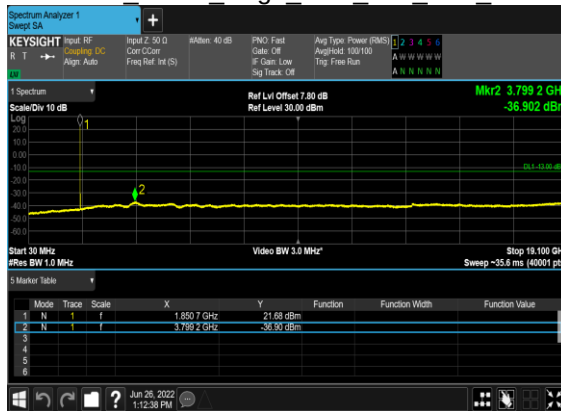
B7_N2(10M)_DFT-s-OFDM BPSK Edge 1RB Left Low CH
