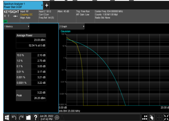
B7_N5(20M)_DFT-s-OFDM_PI_2-BPSK Edge 1RB Left Low CH
