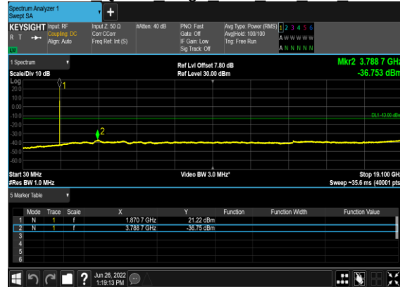
B7_N2(20M)_DFT-s- OFDM QPSK Edge 1RB Left Mid CH
