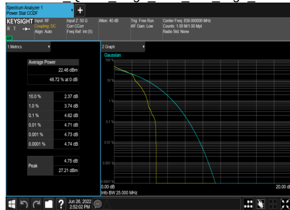
B7_N5(20M)_DFT-s-OFDM QPSK Edge 1RB Left High CH
