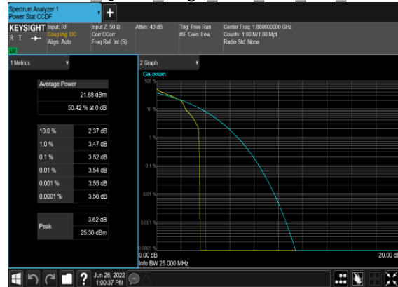
B7_N2(20M)_DFT-s-OFDM QPSK Edge 1RB Left Mid CH
