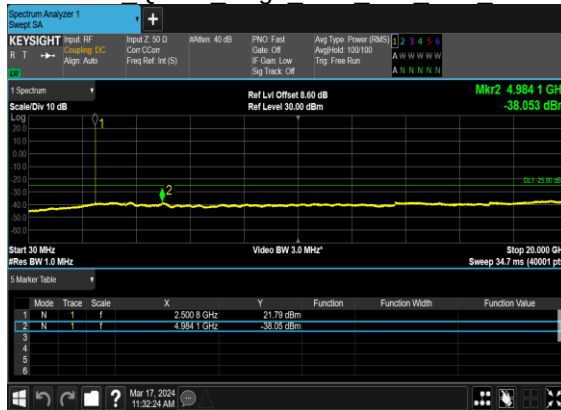
B2_N7(5M)_DFT-s-OFDM QPSK Edge 1RB Left Low CH
