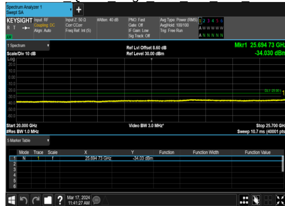
B2_N7(20M)_DFT-s-OFDM QPSK Edge 1RB Left Low CH
