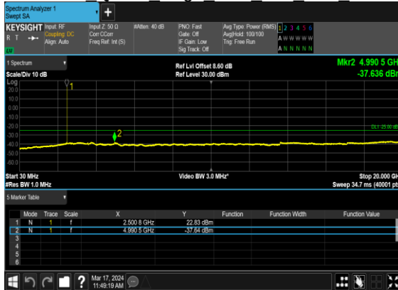
B2_N7(40M)_DFT-s-OFDM QPSK Edge 1RB Left Low CH
