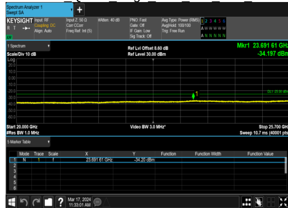
B2_N7(5M)_DFT-s-OFDM QPSK Edge 1RB Left Low CH
