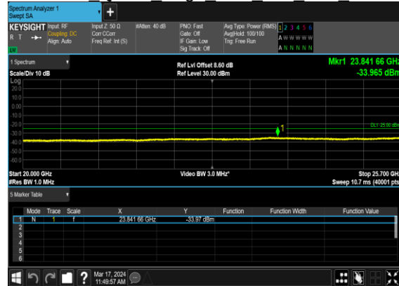
B2_N7(40M)_DFT-s-OFDM QPSK Edge 1RB Left Low CH
