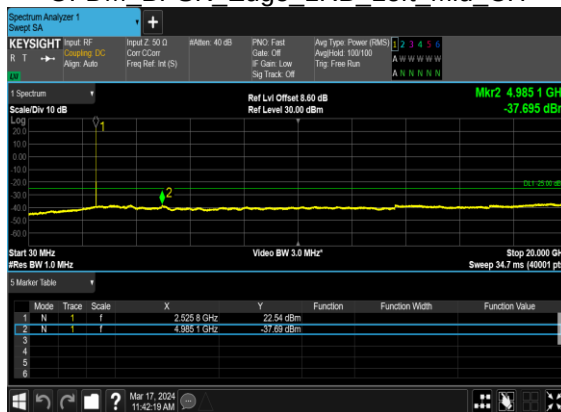
B2_N7(20M)_DFT-s-OFDM BPSK Edge 1RB Left Mid CH
