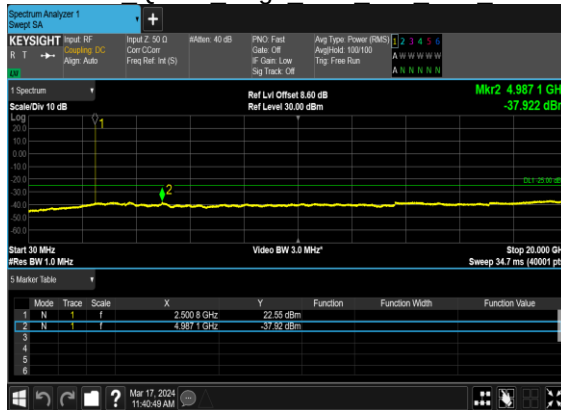
B2_N7(20M)_DFT-s-OFDM QPSK Edge 1RB Left Low CH
