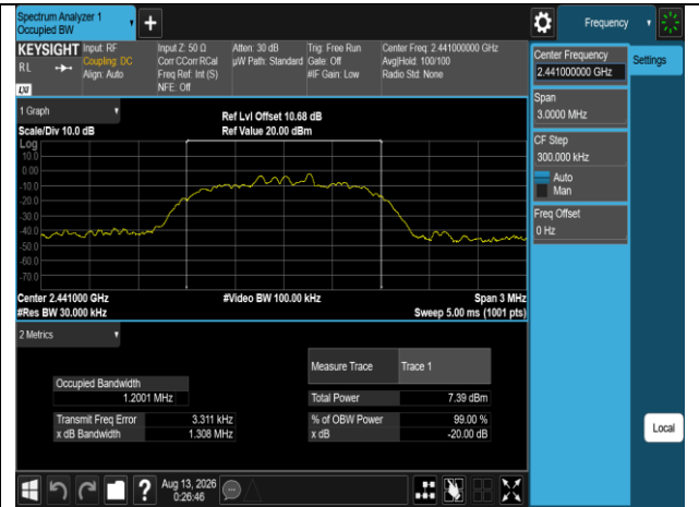
OBW 20dB 8DPSK 3M DH5 2441MHz
