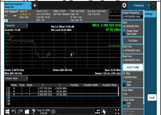
Hopping Band Edge 8DPSK 3M DH5 2480MHz
