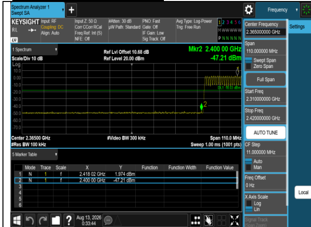
Hopping Band Edge GFSK 1M DH5 2402MHz
