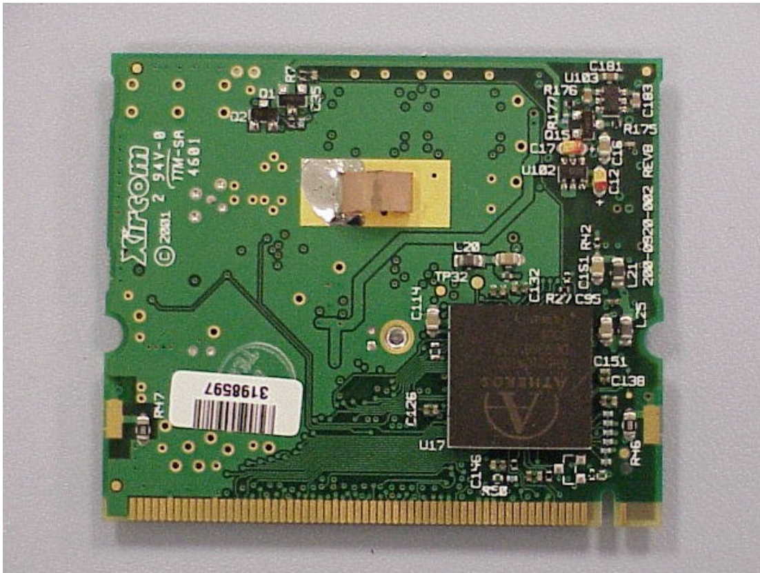
Back side of Mini PCI card
