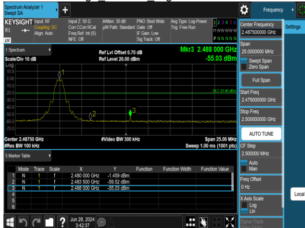
Band Edge BLE 1M HighCH39-2480MHz
