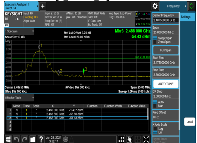
Band Edge BLE 2M HighCH39-2480MHz
