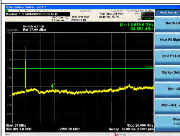
LTE Band 2, 20MHz-Mid CH
