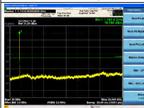
LTE Band 66, 20MHz-Mid CH
