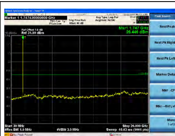
LTE Band 66, 1.4MHz-Mid CH
