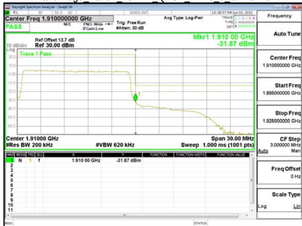
Band Edge Band2 20MHz QPSK RB1 0 CH18700
