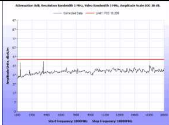
1-18GHz, Horizontal (8DPSK)
