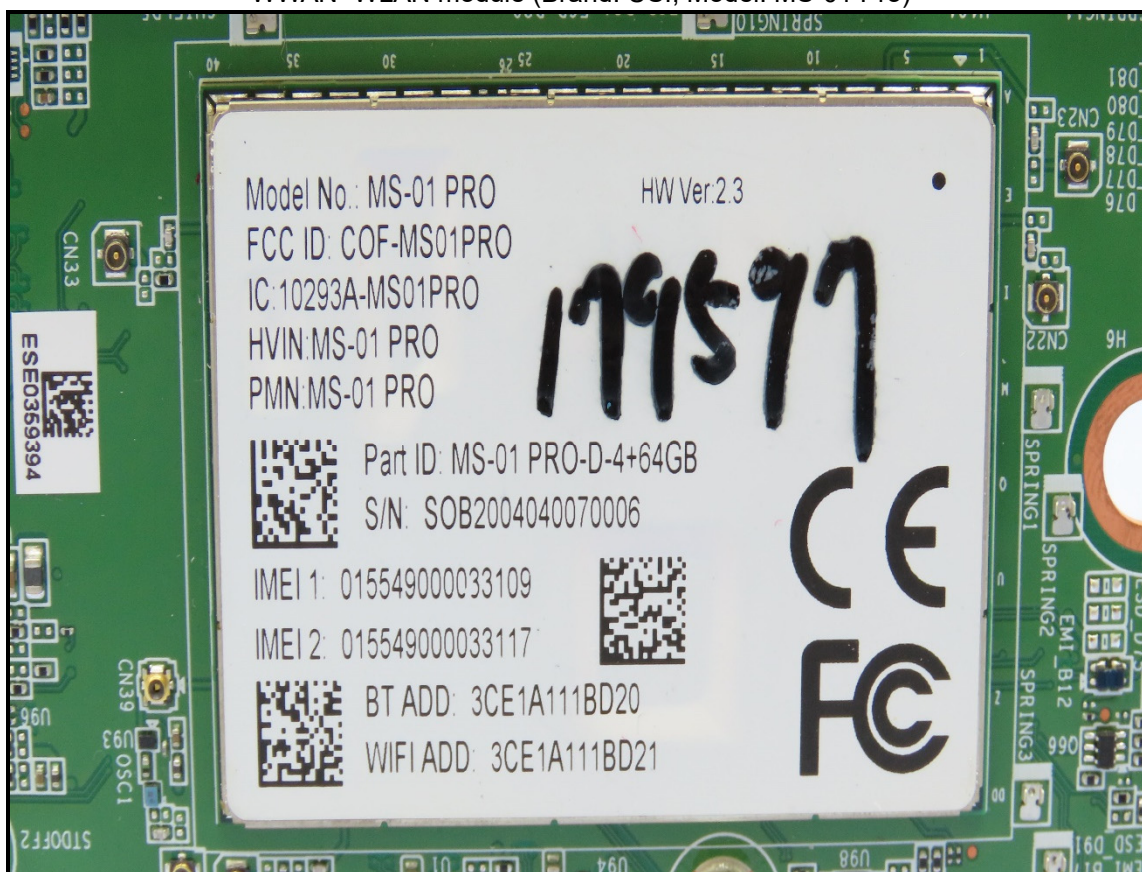
WWAN+WLAN module (Brand: USI, Model: MS-01 Pro)
