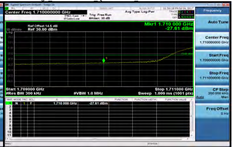
Band Edge Band4 20MHz QPSK 100 0 LowCH20050-1720
