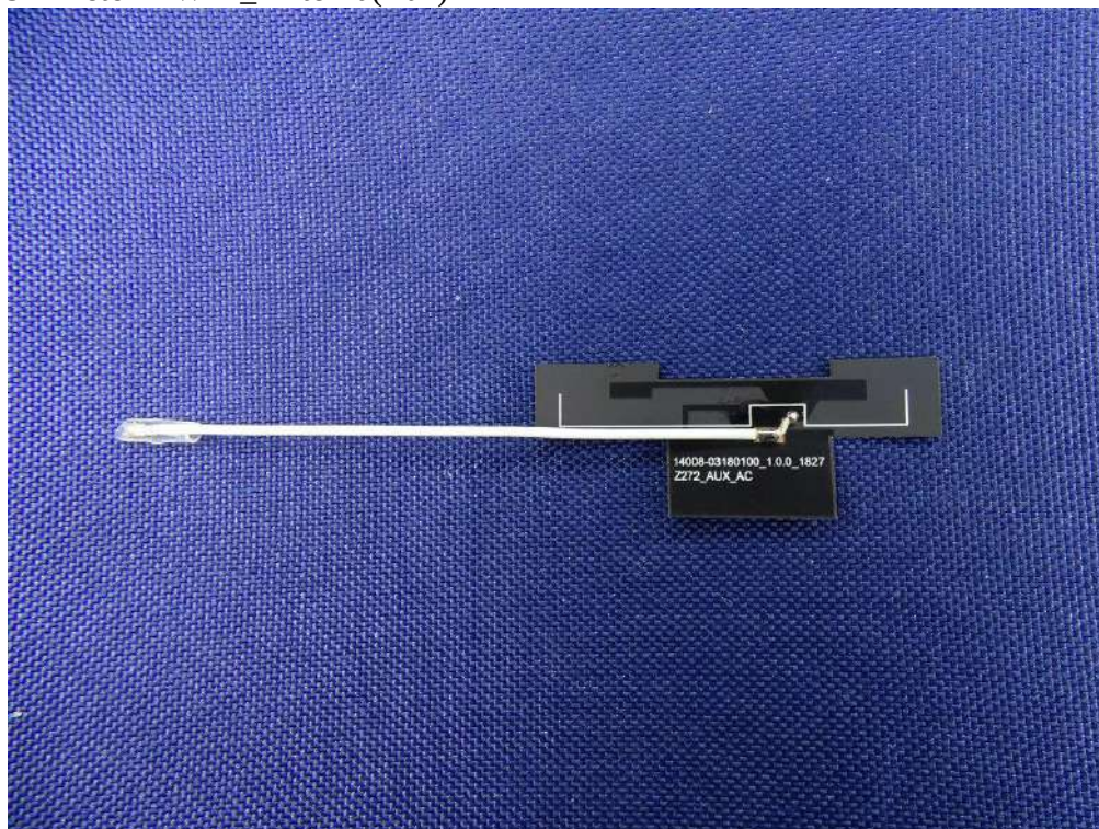
(23) EUT Photo WiFi_Antenna(Aux)
