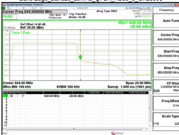
Band Edge Band26 10MHz QPSK RB50 0 CH26990
