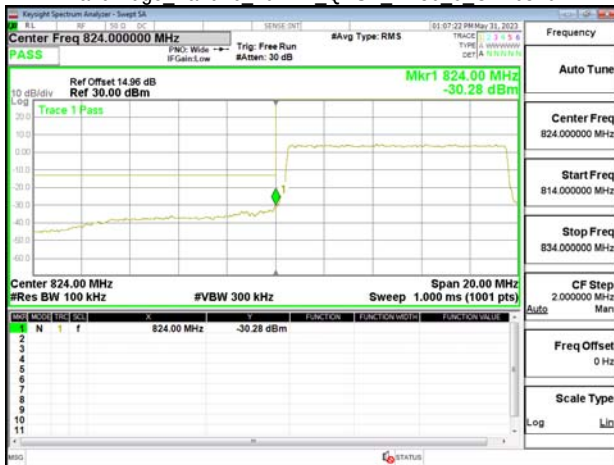
Band Edge Band26 10MHz QPSK RB50 0 CH26990
