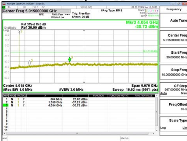
Band71 20MHz QPSK RB1 0 CH133297
