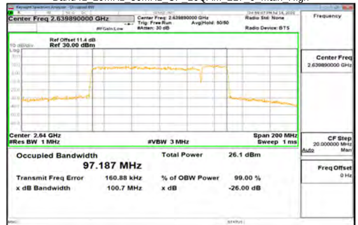
Band41 20MHz 80MHz CP 16QAM 217 0 Main High
