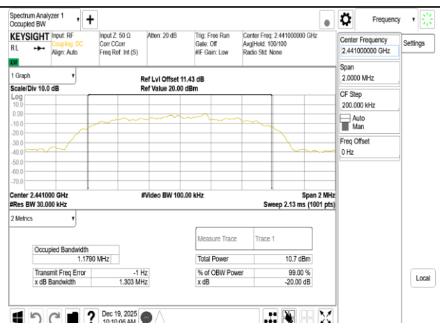
IC OBW 99% 8DPSK 3M DH5 2441MHz
