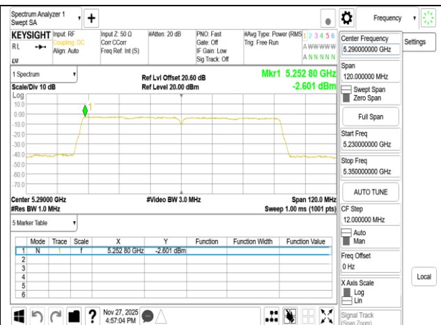
802.11ac 80MHz Chain1 5290MHz
