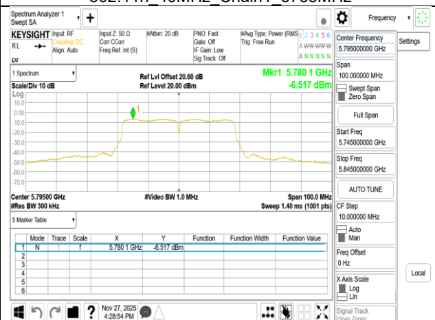
802.11n 40MHz Chain1 5795MHz
