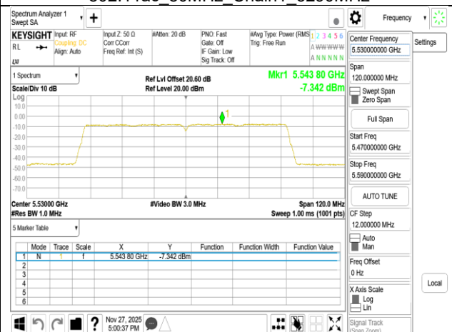
802.11ac 80MHz Chain1 5530MHz
