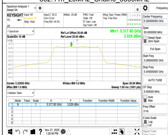
802.11n 20MHz Chain0_ 5320MHz
