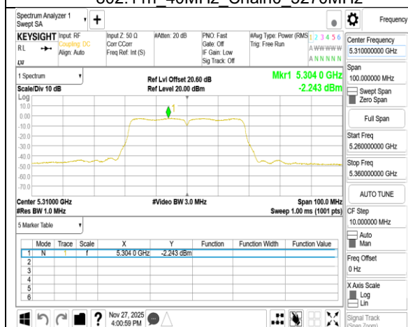
802.11n 40MHz Chain0 5310MHz
