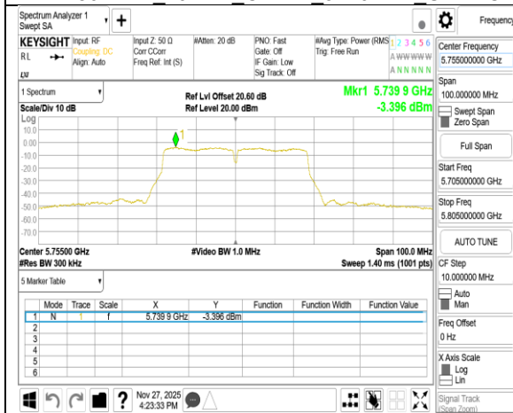
802.11n 40MHz Chain0 5755MHz
