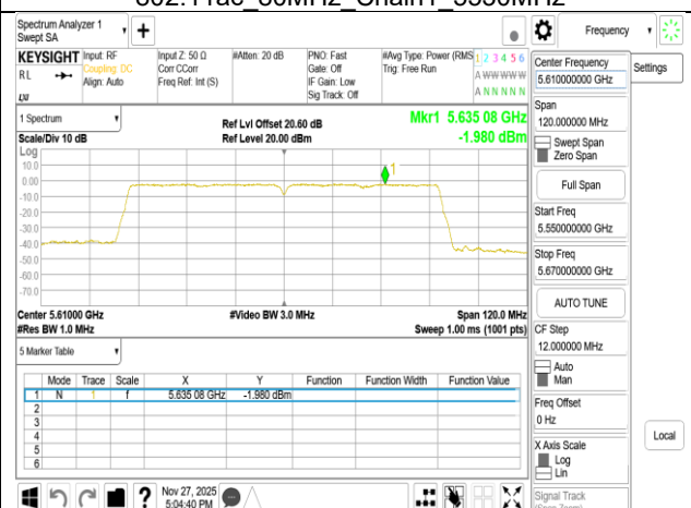
802.11ac 80MHz Chain1 5610MHz
