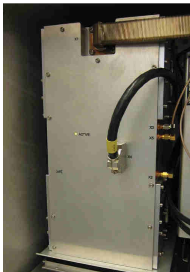
Fig. 4.6 SCANTER 5102/5202 SSPA module - 4 x 50 W PA modules
