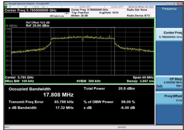
U-NII-3 6dB Bandwidth-802.11n(40MHz) ,5755MHz,Ant1
