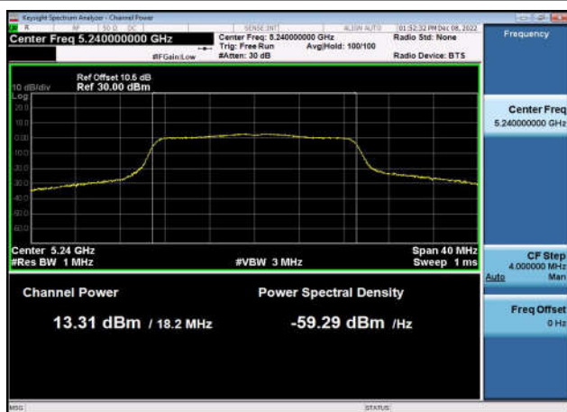
U-NII-1 Output Power-802.11n(40MHz) ,5230MHz,Ant1
