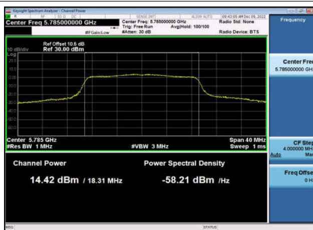
U-NII-3 Output Power-802.11ac(20MHz) ,5785MHz,Ant1
