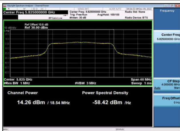
U-NII-3 Output Power-802.11n(20MHz) ,5825MHz,Ant1
