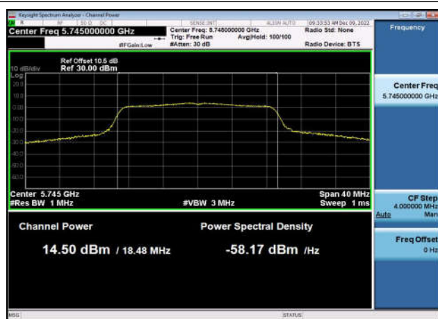
U-NII-3 Output Power-802.11ac(20MHz) ,5745MHz,Ant1
