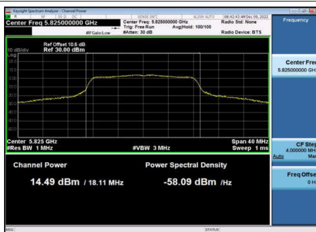
U-NII-3 Output Power-802.11ac(20MHz) ,5785MHz,Ant1
