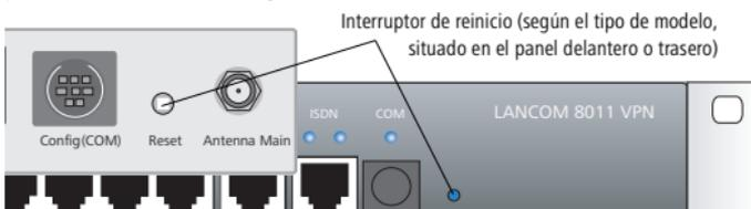
El botón de reset tiene generalmente dos funciones diferentes. La función de reinicio o la función de reset a "factory default", dependiendo del tiempo que esté empujando.
