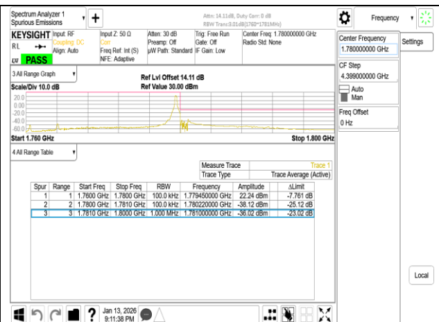
Band66 20MHz CP OFDM SCS15kHz QPSK RB1_105 CH354000
