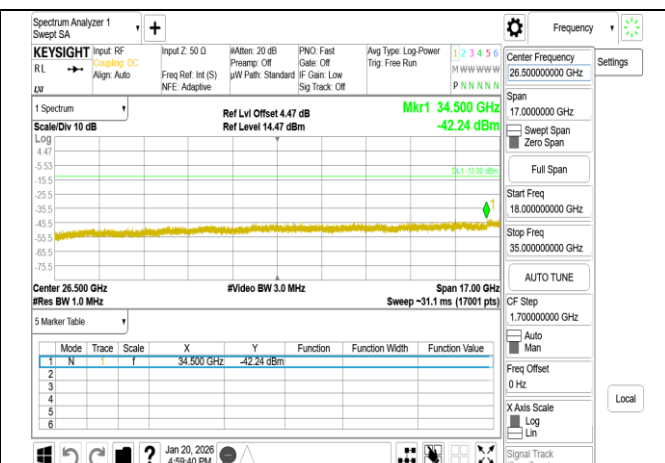
Band77-Part27 15MHz DFT s OFDM SCS30kHz BPSK RB1 1 CH630500 upper 18G
