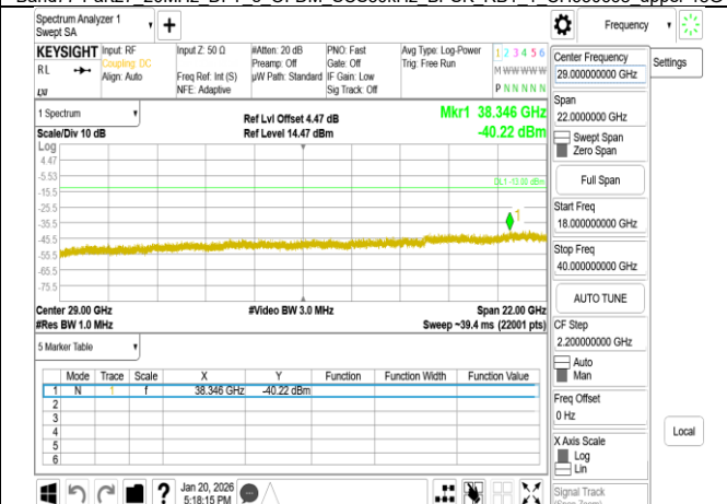
Band77-Part27 20MHz DFT s OFDM SCS30kHz BPSK RB1 1 CH633334 upper 18G
