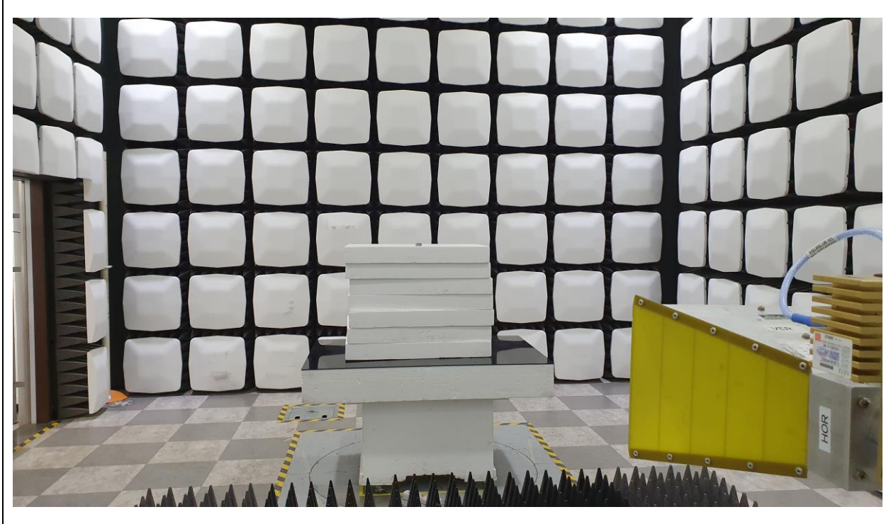
Test distance : 3 m, height of table : 1.5 m
