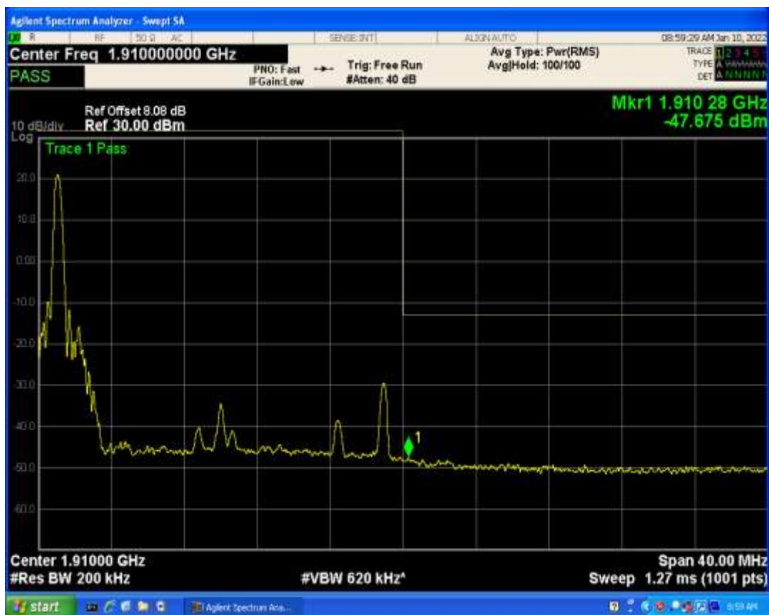
Band2 QPSK BW=20MHz Channel=19100 RB Size=100 Position=#0
