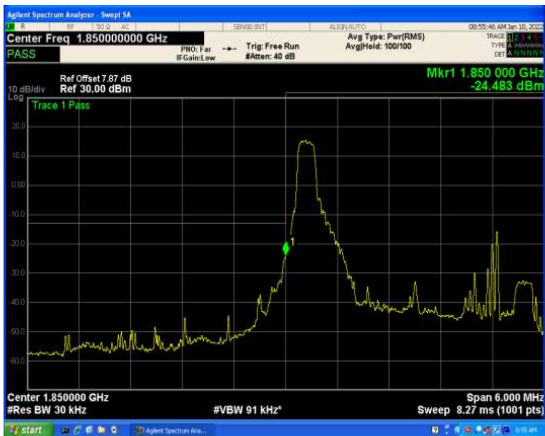
Band2 QPSK BW=20MHz Channel=18700 RB Size=100 Position=#0
