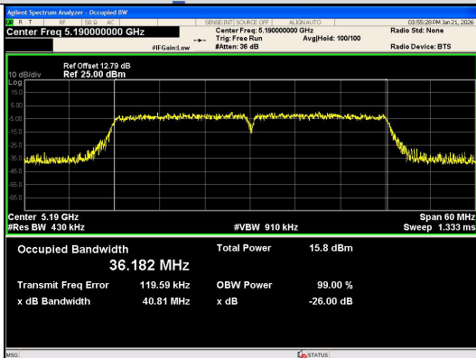
IEEE 802.11ax_Channel 38_40MHz_Antenna 0_RU&Index SU
