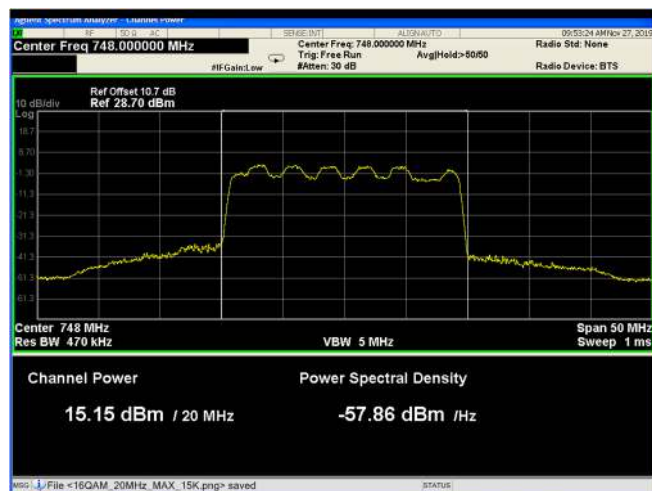
Figure 40: 16QAM 20MHz B.W.; 748.0MHz, 30kHz
