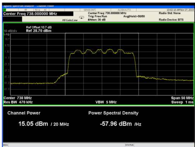
Figure 35: 16QAM 20MHz B.W.; 738.0MHz, 60kHz
