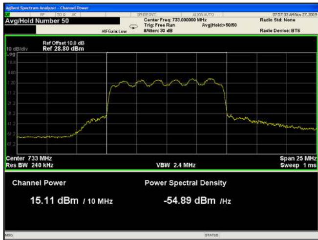
Figure 15: 16QAM 10MHz B.W.; 733.0MHz, 15kHz
