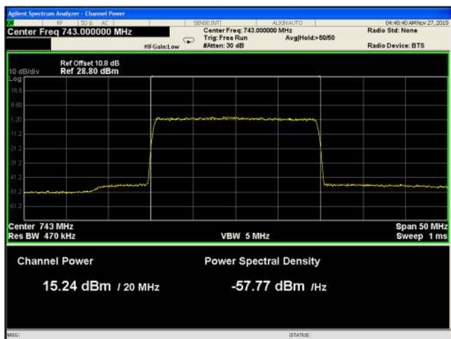
Figure 69: 64QAM 20MHz B.W.; 743.0MHz, 15kHz
