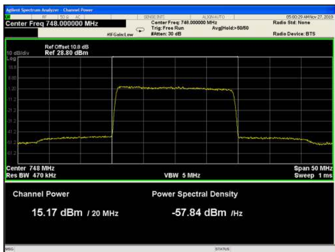
Figure 73: 256QAM 5MHz B.W.; 748.0MHz, 30kHz
