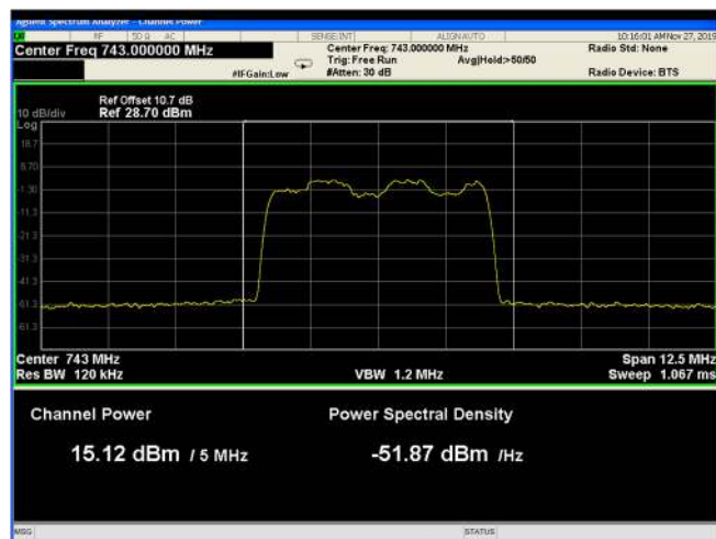
Figure 12: 16QAM 5MHz B.W.; 743.0MHz, 30kHz
