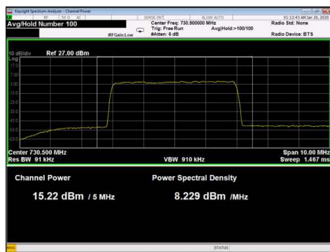
Figure 76: 256QAM 5MHz B.W.; 730.5MHz, 30kHz
