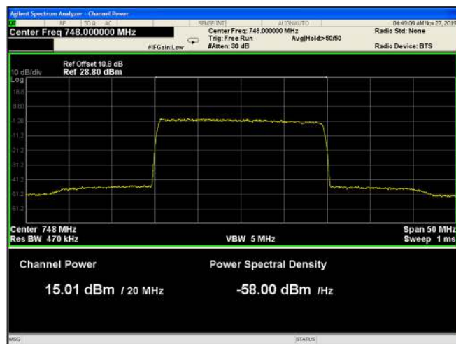
Figure 72: 256QAM 5MHz B.W.; 748.0MHz, 15kHz
