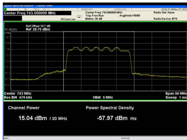
Figure 38: 16QAM 20MHz B.W.; 743.0MHz, 60kHz
