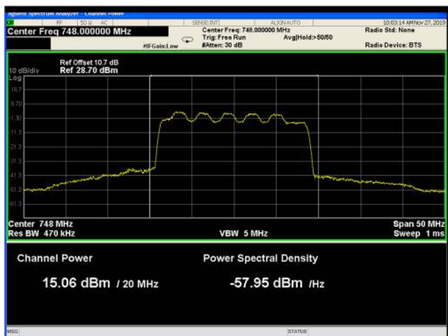
Figure 41: 16QAM 20MHz B.W.; 748.0MHz, 60kHz
