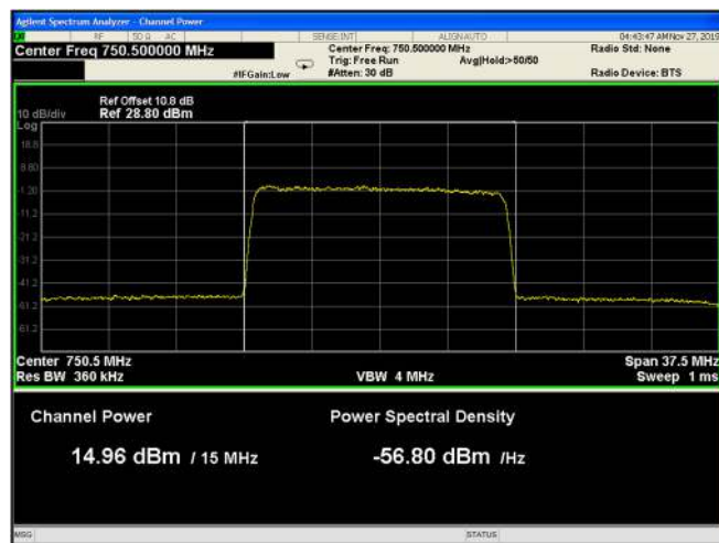
Figure 64: 64QAM 15MHz B.W.; 750.5MHz, 30kHz
