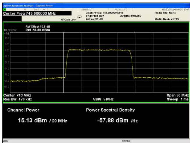
Figure 71: 64QAM 20MHz B.W.; 743.0MHz, 60kHz
