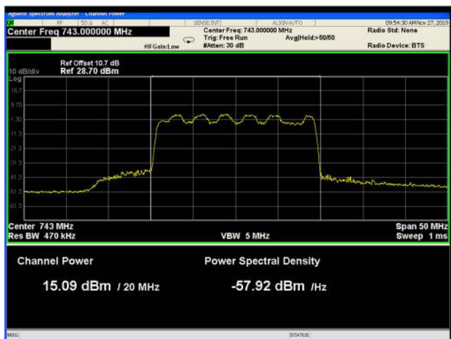
Figure 37: 16QAM 20MHz B.W.; 743.0MHz, 30kHz
