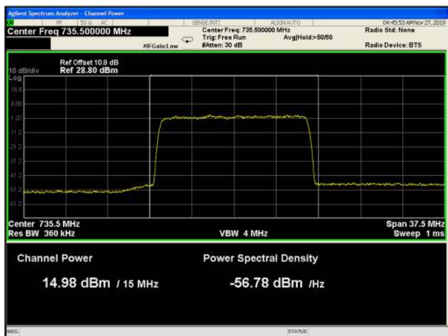
Figure 59: 64QAM 15MHz B.W.; 735.5MHz, 60kHz
