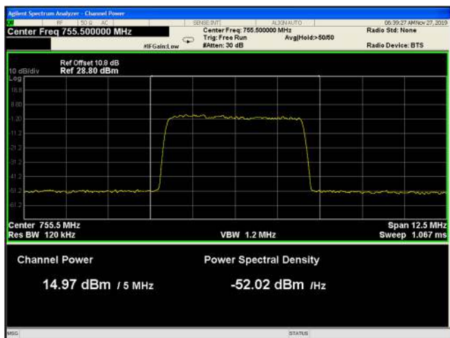
Figure 47: 64QAM 5MHz B.W.; 755.5MHz, 30kHz
