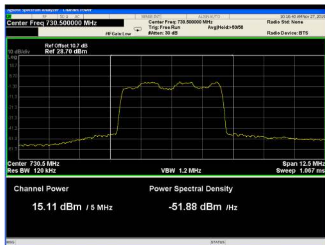
Figure 10: 16QAM 5MHz B.W.; 730.5MHz, 30kHz
