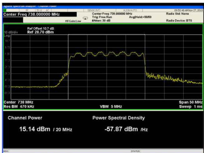
Figure 33: 16QAM 20MHz B.W.; 738.0MHz, 15 kHz
