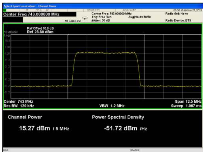
Figure 45: 64QAM 5MHz B.W.; 743.0MHz, 30kHz
