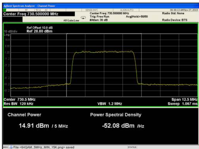
Figure 43: 64QAM 5MHz B.W.; 730.5MHz, 30kHz
