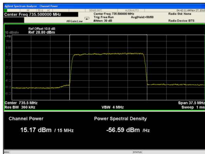
Figure 58: 64QAM 15MHz B.W.; 735.5MHz, 30kHz
