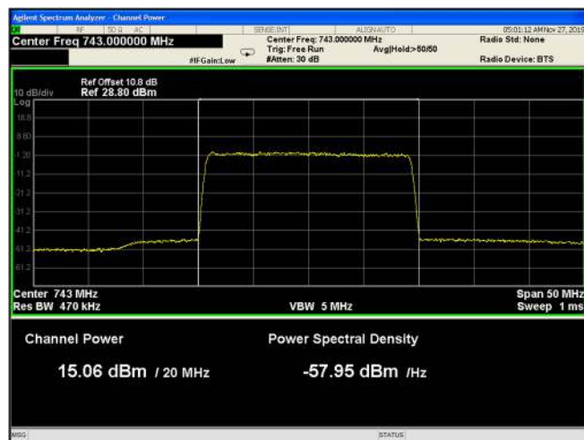
Figure 70: 64QAM 20MHz B.W.; 743.0MHz, 30kHz
