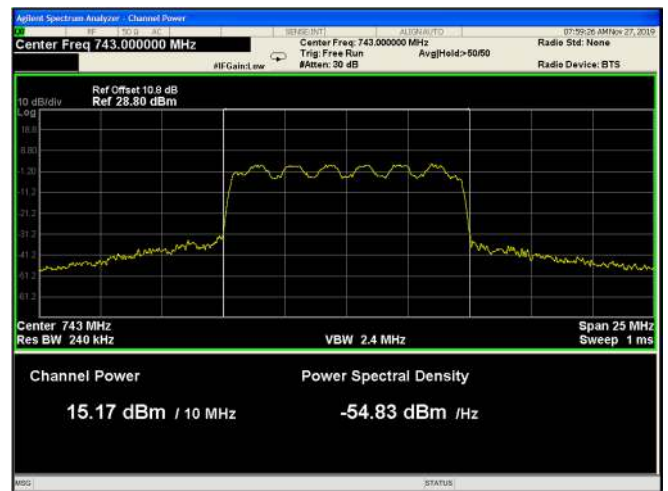
Figure 18: 16QAM 10MHz B.W.; 743.0MHz, 15kHz
