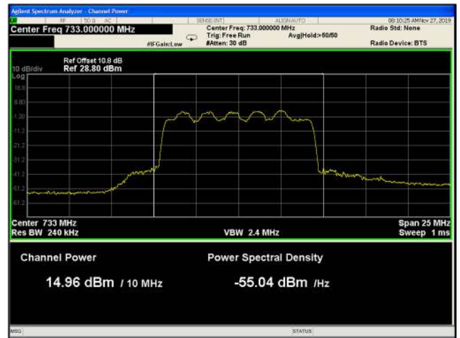
Figure 16: 16QAM 10MHz B.W.; 733.0MHz, 30kHz
