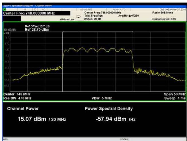
Figure 39: 16QAM 20MHz B.W.; 748.0MHz, 15kHz
