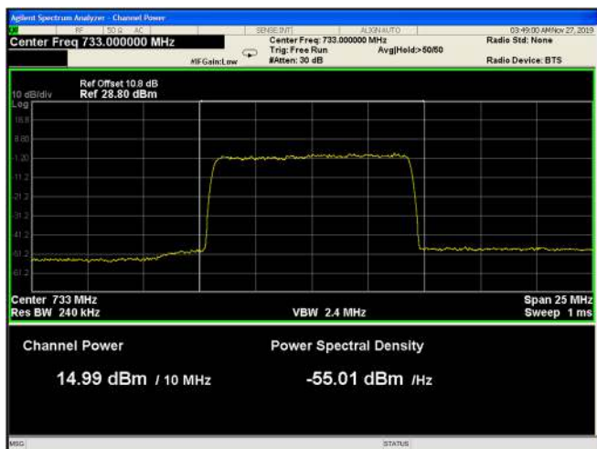
Figure 49: 64QAM 10MHz B.W.; 733.0MHz, 30kHz
