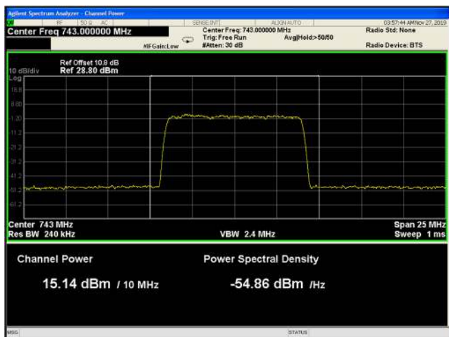
Figure 53: 64QAM 10MHz B.W.; 743.0MHz, 60kHz
