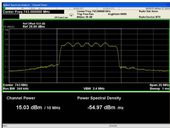
Figure 19: 16QAM 10MHz B.W.; 743.0MHz, 30kHz
