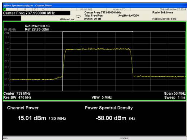
Figure 67: 64QAM 20MHz B.W.; 738.0MHz, 30kHz
