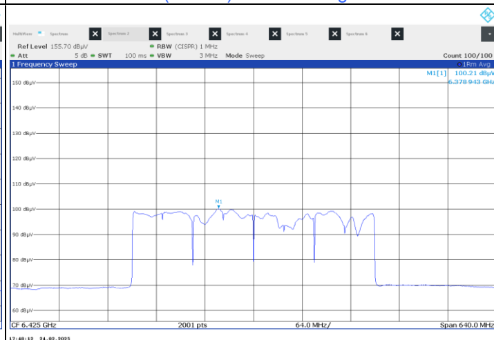
802.11be (EHT320) Beamforming : CH 95
